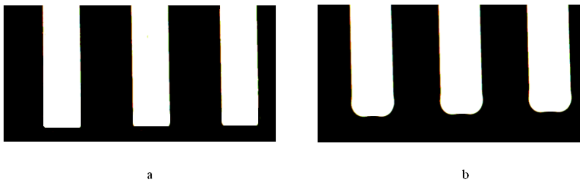
6.24 pav. Brūkšnių forma: a – optimalus židinio nuotolis; b – esant 10\ \mu\text{m} paklaidai
