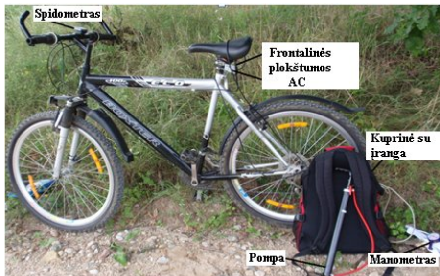
2.3 pav. Eksperimente naudotas dviratis, skaitmeninis belaidis spidometras, kuprinė su įranga, manometras, pompa ir pagreičio jutikliai
