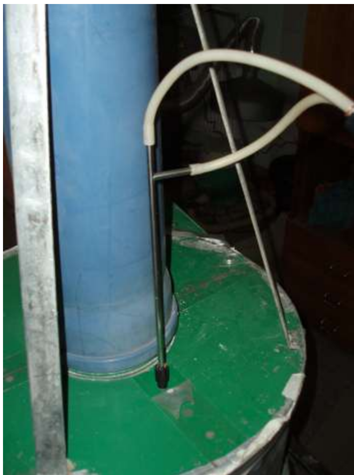
2.3 pav. Oro dinaminio slėgio matavimas ciklono konstrukcijos viduje
