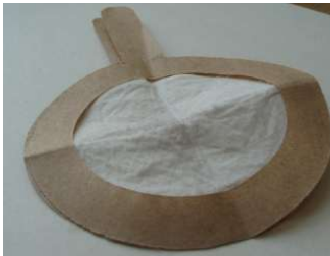
3.5 pav. AFA–VP–20 audinio filtras, panaudojamas oro koncentracijos nustatymui
