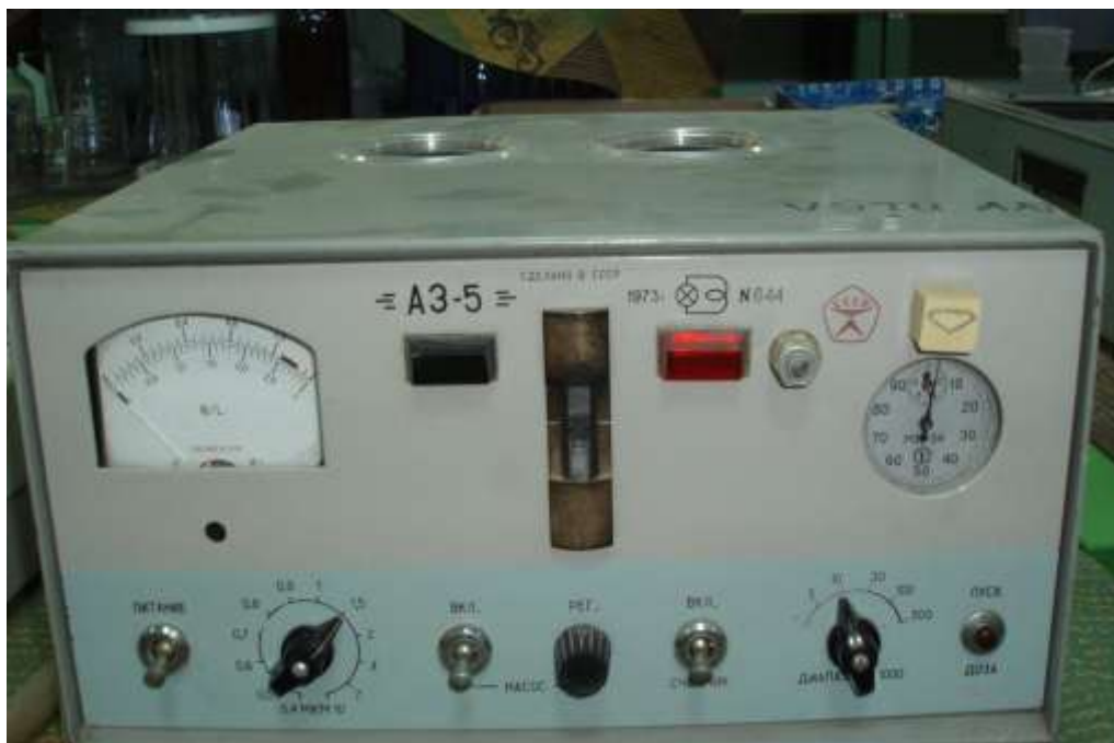
3.6 pav. Fotoelektrinis aerozolių dalelių skaitiklis A3-5
