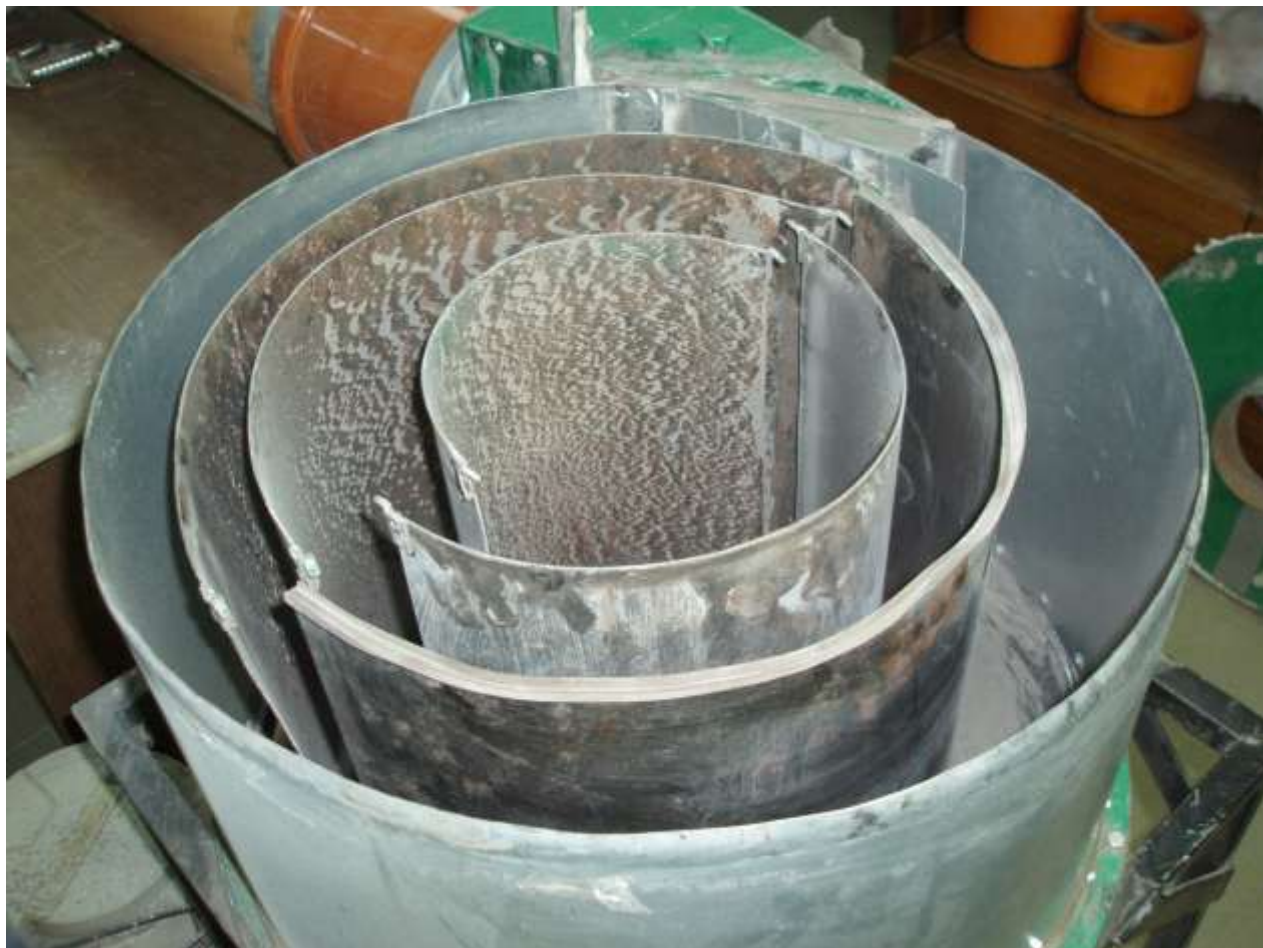
3.4 pav. Šešiakanalio ciklono vidinės konstrukcijos sandara
