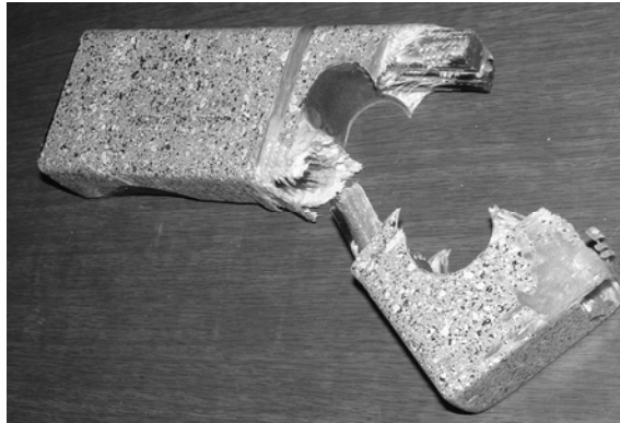
9 pav. Sparno tvirtinimo šakės lūžis ties kaiščiu
