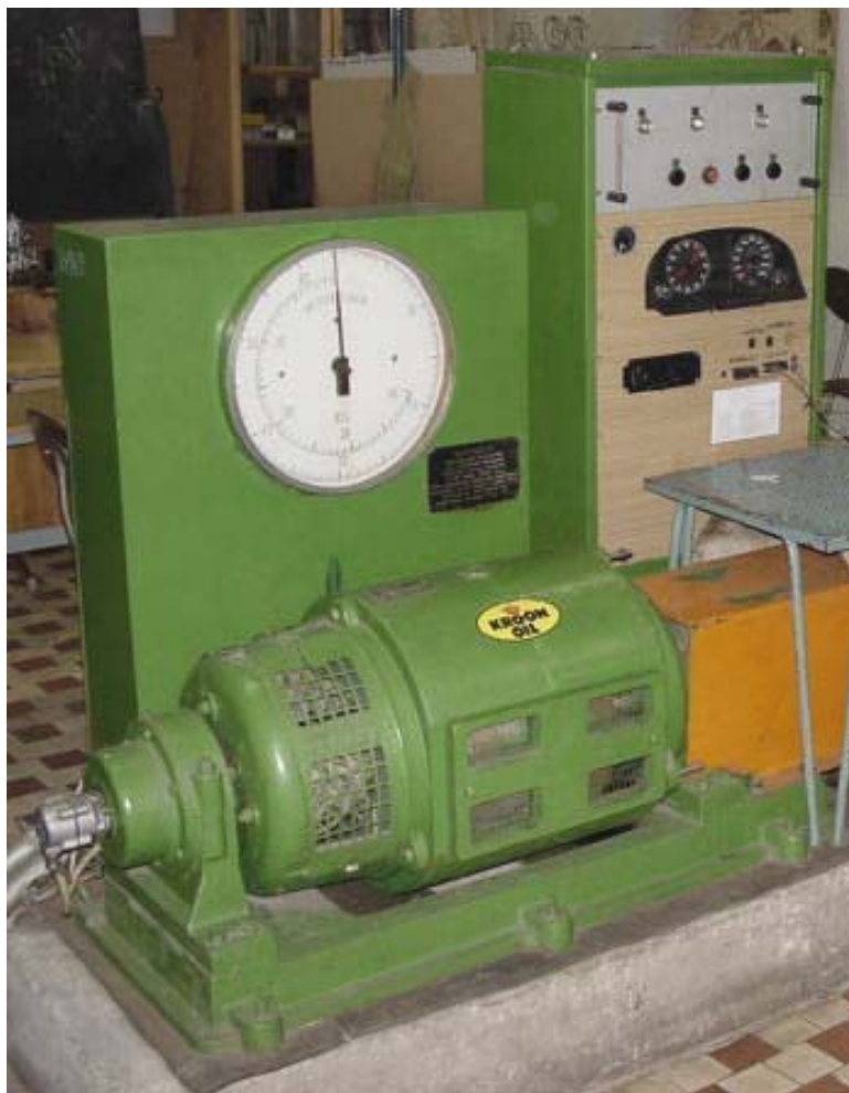
36 pav. Variklių bandymų stendas KI – 5543
