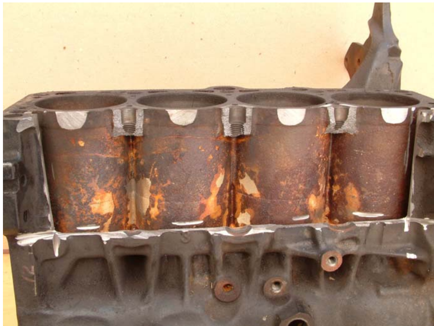
3 pav. Nuosėdos ant vidaus degimo variklio cilindrų išorinių paviršių
