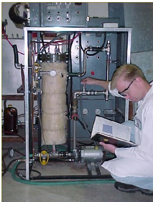
5 pav. Kompanijos Amalgamated Technologies Inc. sukonstruota įranga, skirta tirti vidaus degimo variklių aušinimo skysčių nuosėdų susidarymą
