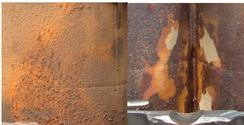
30 pav. Nuosėdos ant variklio cilindrų išorinio paviršiaus
