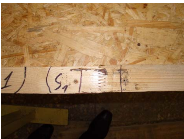
D.5 pav. Dyginė jungtis plonasienės sijos medinėje juostoje
