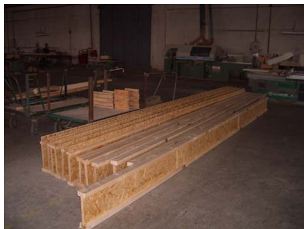
D.3 pav. Medinių plonasienių sijų gamykla (UAB „AHL“, Vilniaus g. 10, Grigiškės, Vilnius)
