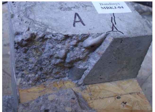
C.14 pav. KMB tarpsluoksnio įlaidinės jungties su „įvorinėmis“ jungėmis suirimo vaizdai
