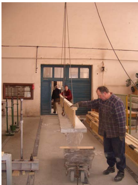
D.12 pav. KMB sijos transportavimas
