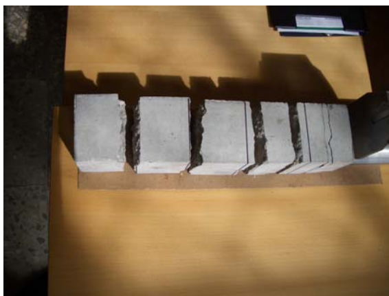
D.2 pav. Betono stiprio tempiant nustatymas skėlimo bandymu nuotraukos
