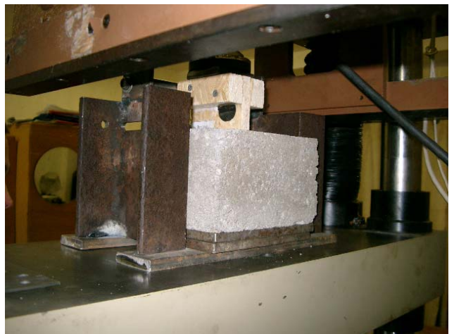
B.10 pav. KMB įleistinių jungčių bandymo įranga (VGTU Medžiagų mechanikos katedros laboratorija)
