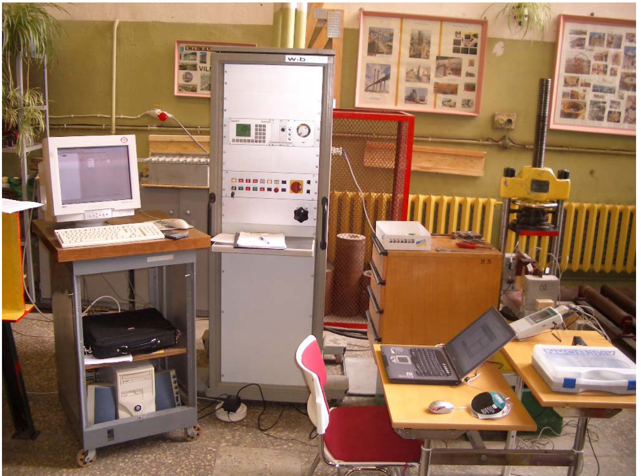
C.11 pav. KMB tarp sluoksnių jungties su „įvorinėmis“ jungėmis bandymo įranga (VGTU, Metalinių ir medinių konstrukcijų katedros laboratorija)
