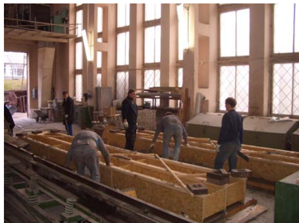
D.9 pav. Bandinių paruošimas betonavimui ir betono liejimo darbai
