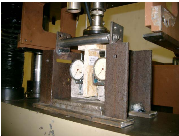
B.10 pav. KMB įleistinių jungčių bandymo įranga (VGTU Medžiagų mechanikos katedros laboratorija)
