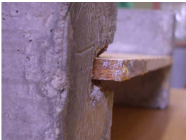
C.14 pav. KMB tarpsluoksnio įlaidinės jungties su „įvorinėmis“ jungėmis suirimo vaizdai
