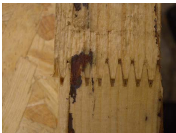
D.5 pav. Dyginė jungtis plonasienės sijos medinėje juostoje
