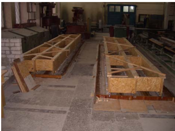
D.9 pav. Bandinių paruošimas betonavimui ir betono liejimo darbai
