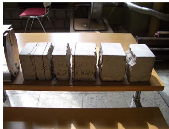
D.2 pav. Betono stiprio tempiant nustatymas skėlimo bandymu nuotraukos
