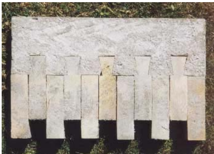
3.10 pav. KMB besijinės perdangos skerspjūvio vaizdas pagal [135]
