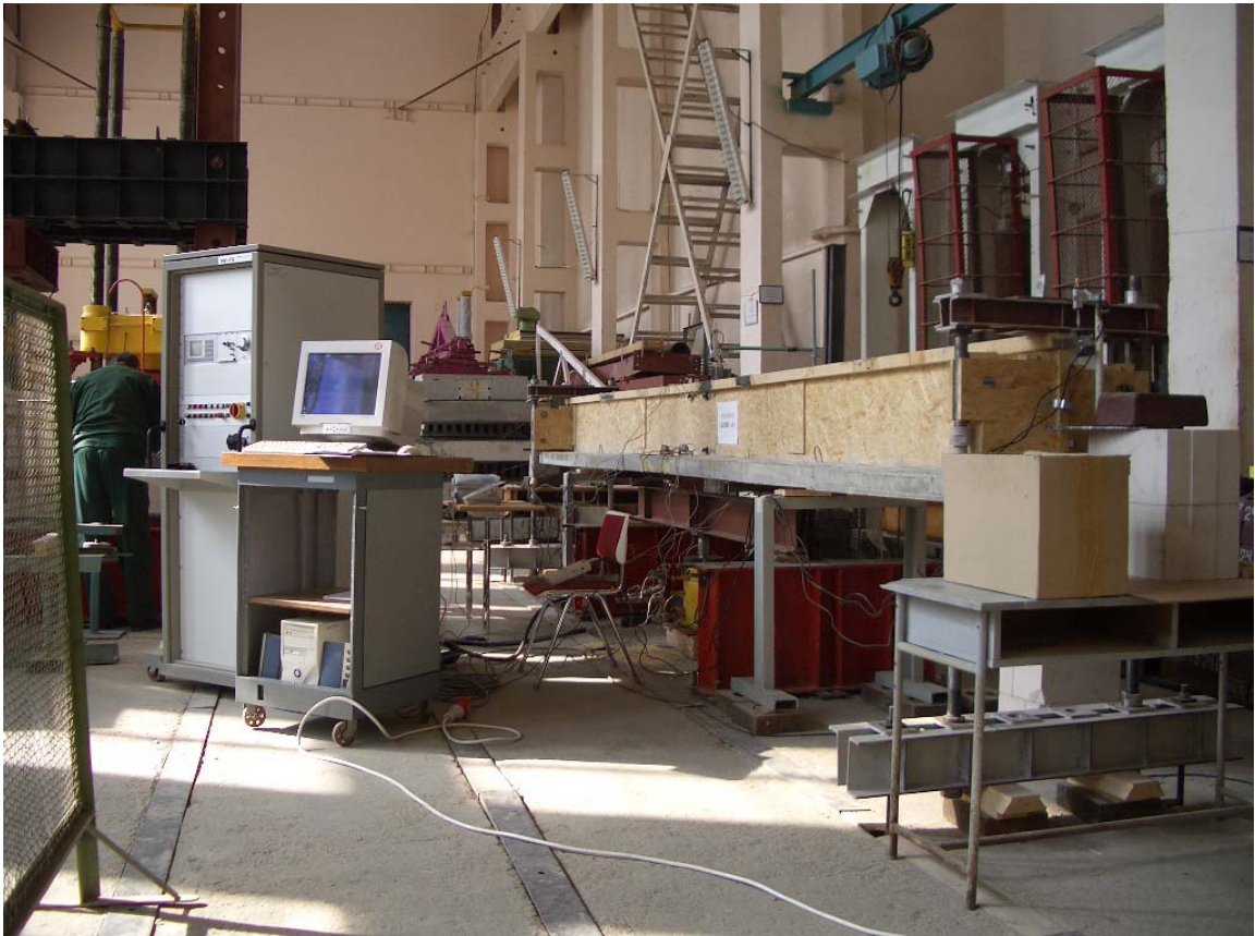
4.11 pav. KMB sijų bandymo įrangos ir bandinio vaizdas
