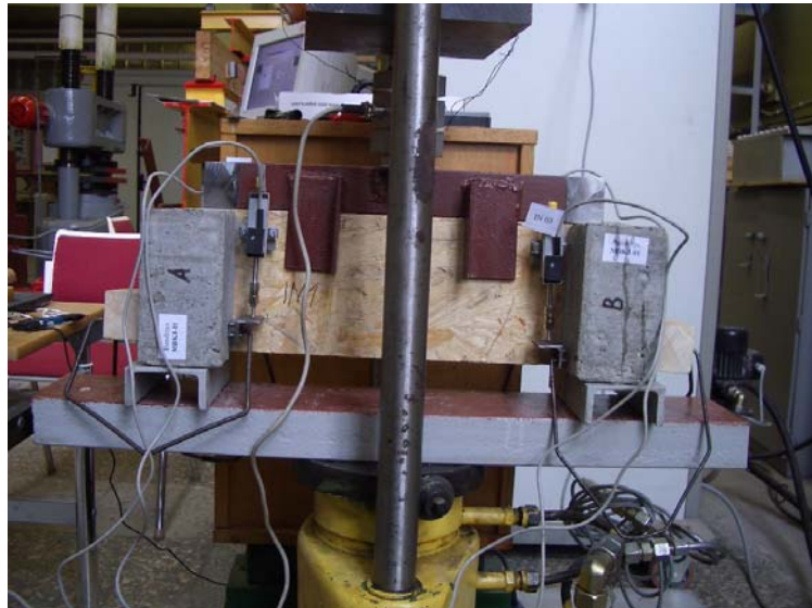
4.19 pav. Bandymo įranga ir į ją įstatytas bandinys
