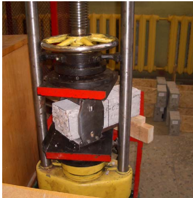
4.17 pav. Bandinys ir bandymo įranga nustatant betono stiprį tempiant skėlimu
