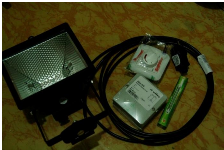
3.2 pav. Dirbtinės šviesos šaltinio elementai: 1 – prožektorius; 2 – halogeninė lemputė; 3 – įtampos reguliatorius; 4 – įtampos reguliatoriaus dėžutė
