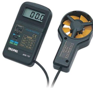
3.7 pav. Anemometras TECPEL AVM 702
