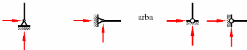
3.2 pav. Neslankios lankstinės atramos skaičiuojamoji schema (Nagevičius et al. 2006)
