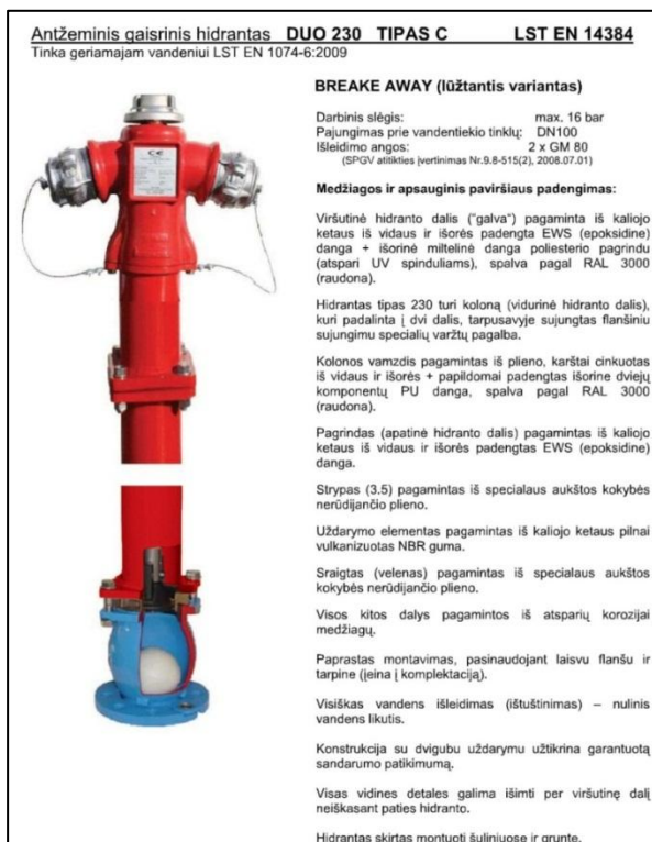
3.7 pav. Hidranto aprašomoji kortelė
