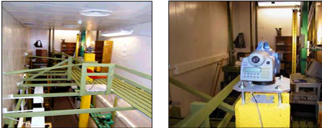
2.1 pav. Suomijos Geodezijos instituto nivelyrų sistemos kalibravimo komparatorius [15]
