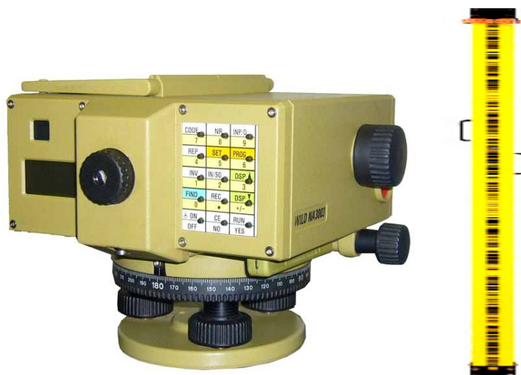
1.6 pav. Skaitmeninis nivelyras Wild NA3003 ir kodinė matuoklė GPCL3 [6, 27]
