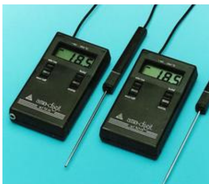
1.7 pav. Kontaktinis elektroninis termometras Ama-digit ad 30 th [7]
