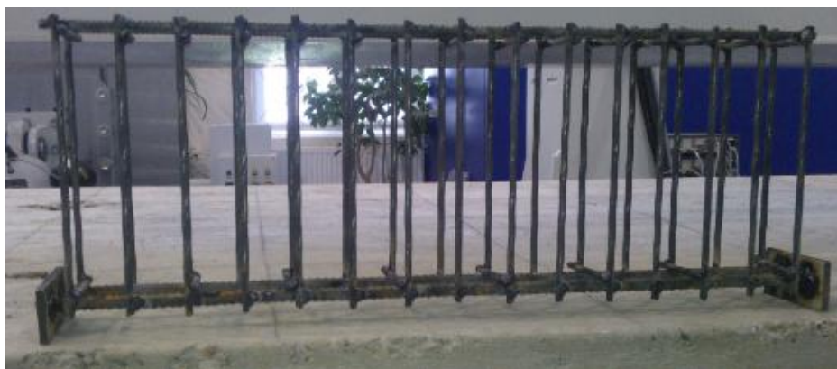
4.3 pav. Armatūros karkasas bandinio armavimui
