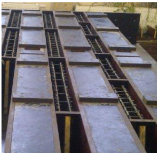
4.5 pav. Bandinių betonavimas
