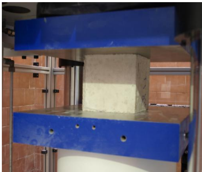
4.1 pav. Betono kubelių bandymas
