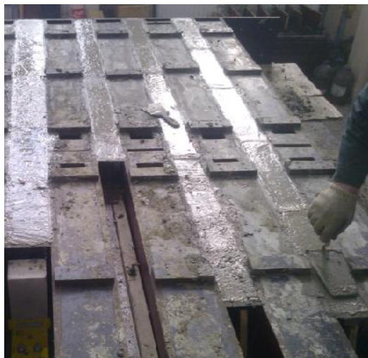
4.5 pav. Bandinių betonavimas
