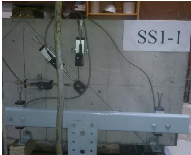
4.8 pav. Matuoklių išdėstymas eksperimentinėje bazėje
