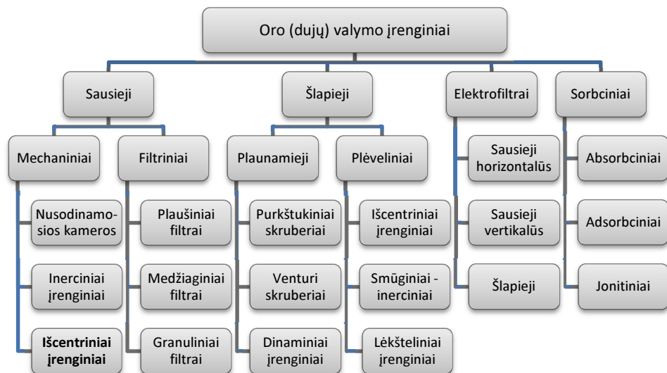
1.1 pav. Oro (dujų) valymo įrenginių klasifikacija (Vatin, Strelec, 2003)
