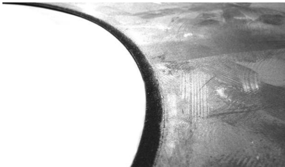
4 pav. Deimantinio sluoksnio paviršius po T14K8 kietlydinio pjaušimo
