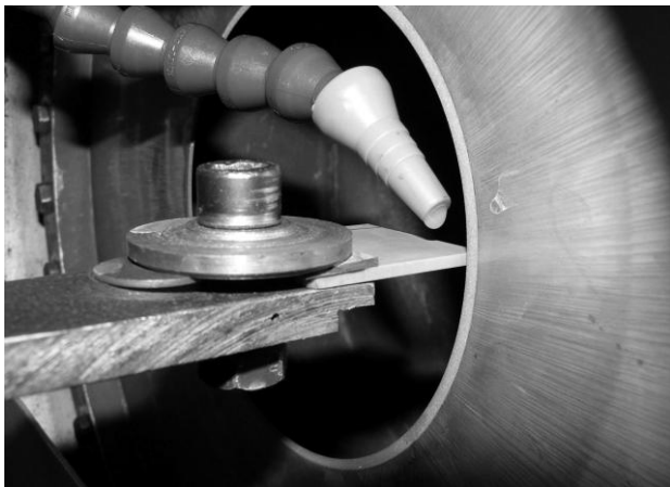
1 pav. Staklių „AJMA3-4“ pjovimo zona (laikiklyje įtvirtinta keramikos plokštelė (baltos spalvos))
