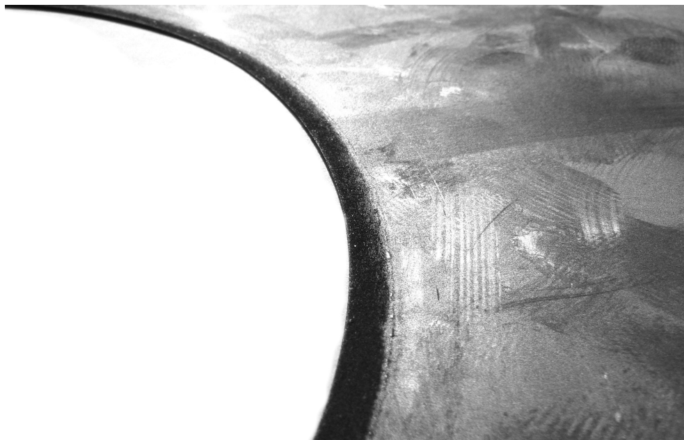
3.13 pav. Disko apsivėlimas pjaunant volframinį T14K8 kietlydinį
