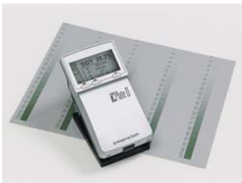
25 pav. „iCPLATE II“ nešiojamas skaitmeninių ir tradicinių ofsetinių spausdinimo formų matavimo prietaisas
