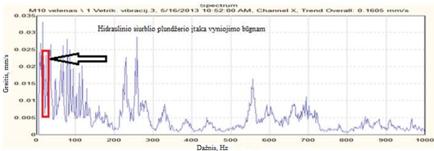
73 pav. Hidraulinio siurblio vertikalųjų vibracijų spektras su plundžerio veikimo dažniu
