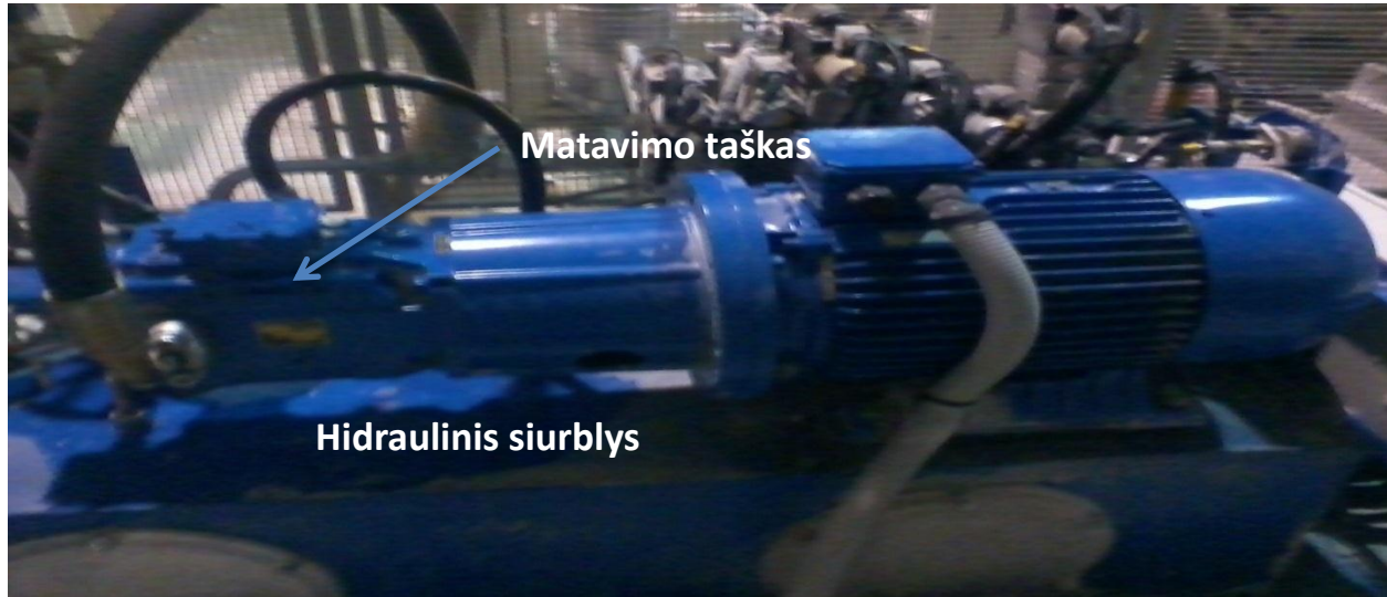
69 pav. Hidraulinio siurblio eksperimento schema
