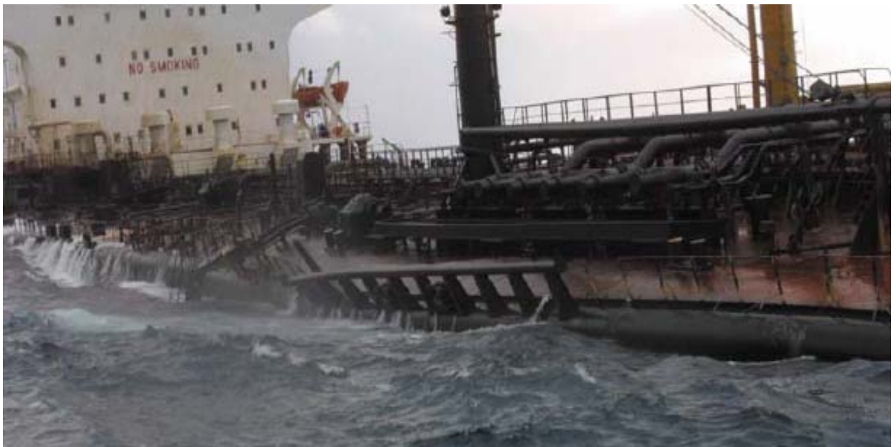
2.20 pav. Tanklaivio „Prestige“ pažeisto korpuso fragmentas
