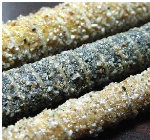
1.3 pav. Neplieninės armatūros paviršius padengtas užpildu (Atutis ir Valivonis 2010)
