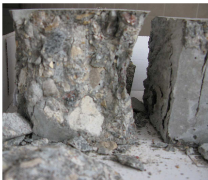
2 pav. Sugniuždyti bandiniai, pagaminti iš betono mišinio B-II, po 28 parų kietėjimo
