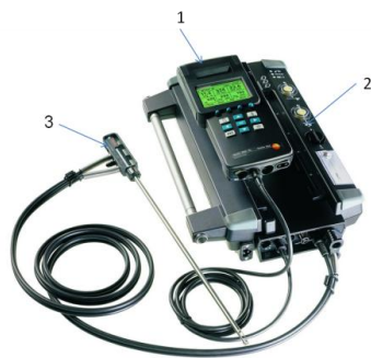
3 pav. Dūmų analizatorius Testo 350 XL: 1 – valdymo blokas, 2 – duomenų apdorojimo įrenginys, 3 – mėginių paėmimo lazdelė.
