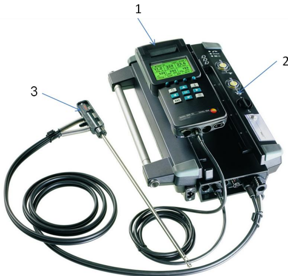
23 pav. Dūmų analizatorius „Testo 350 XL“: 1 – valdymo blokas, 2 – duomenų apdorojimo įrenginys, 3 – mėginių paėmimo lazdelė
