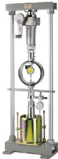
1.7 pav. Grunto CBR nustatymo įranga - laboratorinis įrenginys
