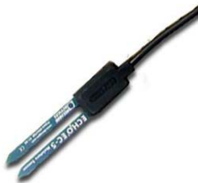
4.4 pav. Drėgnio daviklis „Soil Moisture Smart Sensor“
