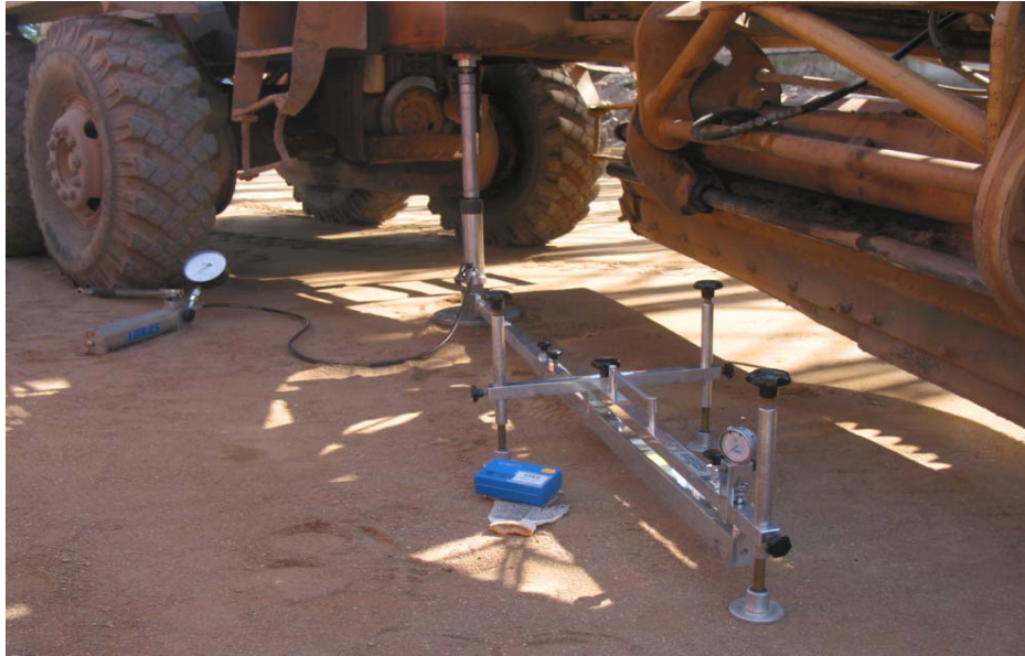
1.8 pav. Statinė sija
