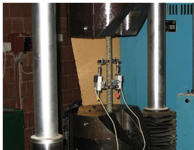
25 pav. Armatūros strypų bandymas
