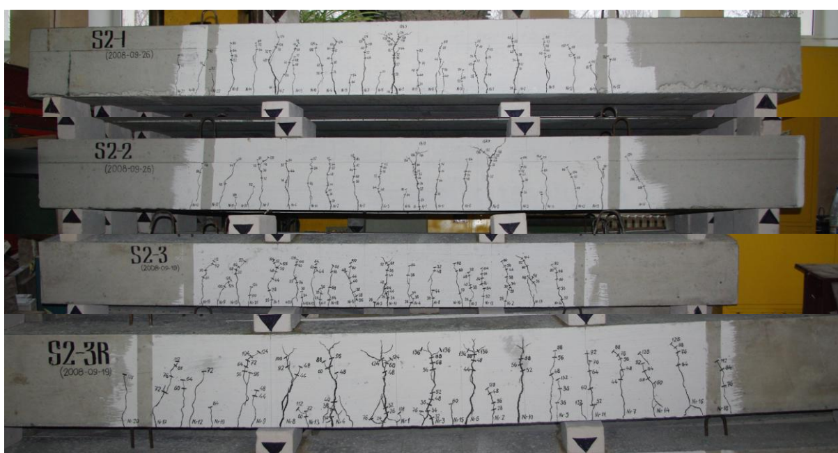
29 pav. II serijos eksperimentinių sijų pleišėjimo pobūdis
