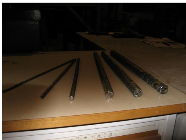
26 pav. Armatūros bandiniai bei įtempių ir deformacijų diagrama ( \varnothing 10 mm)
