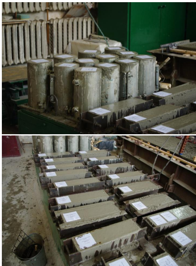
21 pav. Eksperimentinių cilindų, prizmių bei kubelių betonavimas
