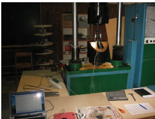
25 pav. Armatūros strypų bandymas
