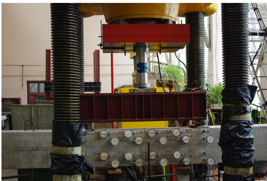
22 pav. Matavimo prietaisų išdėstymas
