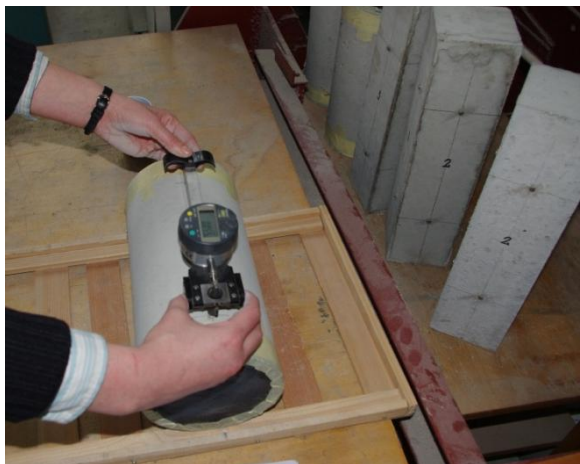
23 pav. Betono susitraukimo sukeltų deformacijų matavimas (kairėje); visų serijų betono laisvosios betono susitraukimo deformacijos (dešinėje)
