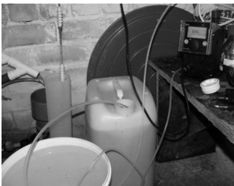
2.4 pav. Geriamojo vandens ruošimo įrenginių stendo patalpa ir koagulianto talpa bei koagulianto dozatorius
