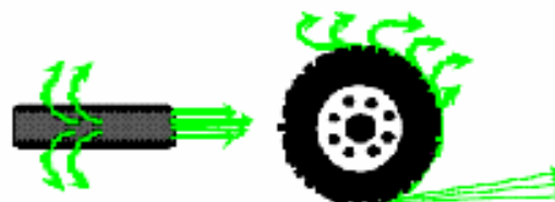
1.6 pav. Druskų ištaškymo bei dulksmo nuo kelio paviršiaus principai (Blomqvist et al., 2001)
