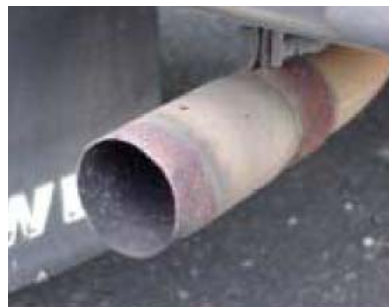
1.16 pav. Reflektoriaus bei išmetimo vamzdžio korozija, sukelta kelių priežiūros druskų (Joshua, 2004)
