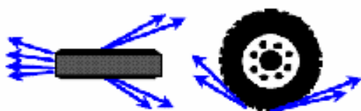
1.6 pav. Druskų ištaškymo bei dulksmo nuo kelio paviršiaus principai (Blomqvist et al., 2001)
