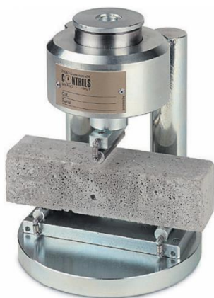
2.7 pav. Stovas lenkimo bandymui atlikti (Controls-Group, 2023)
