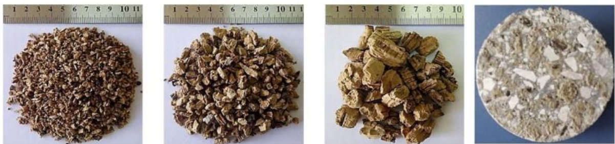
1.5 pav. (I) kamštiena 0–4 mm; (II) kamštiena 4–8 mm; (III) kamštiena 8–16 mm; (IV) betonas su kamštienos užpildu (Junaid et al., 2022)
