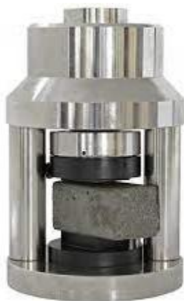
2.8 pav. Stovas gniuždymo bandymui atlikti (Controls-Group, 2023)
