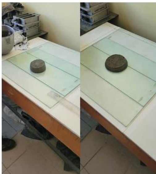
2.9 pav. Sklidaus mišinio sklidumo bandymas
