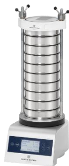
2.1 pav. „Haver EML 200 digital T“ vibracinis sietas (Directindustry, 2023)
