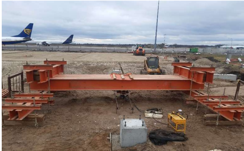
19 pav. Sumontuota polio bandymo sistema statybos aikštelėje (autorius nuotrauka)
