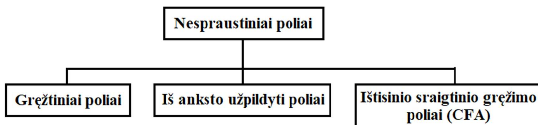
12 pav. Gręžtinių polių klasifikavimas pagal įrengimo būdą pagal K. Flemingą (Fleming ir kt., 2009)
