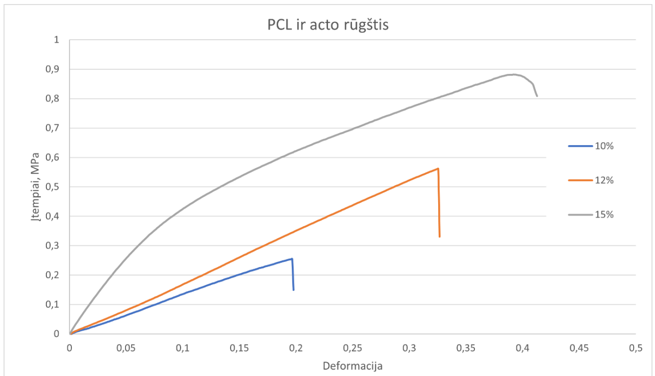
3.7 pav. Įtempių-deformacijos priklausomybės kreivė PCL ir acto rūgšties nanopluoštams
