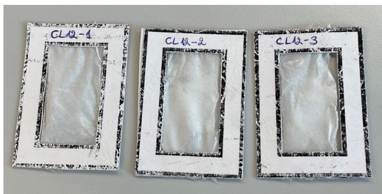
3.1 pav. PCL karkasai paveikti, chloroformu (CL) prieš tempimo bandymą
