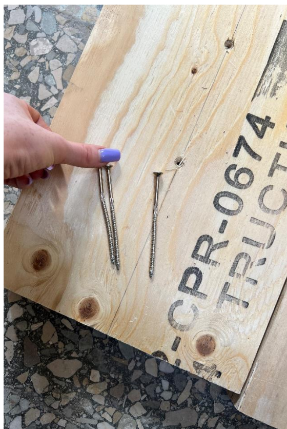
3.18 pav. Medienos jungties su medsraigčiais suirimo forma: lėtas medsraigčių tekėjimas, deformavosi medsraigčiai
