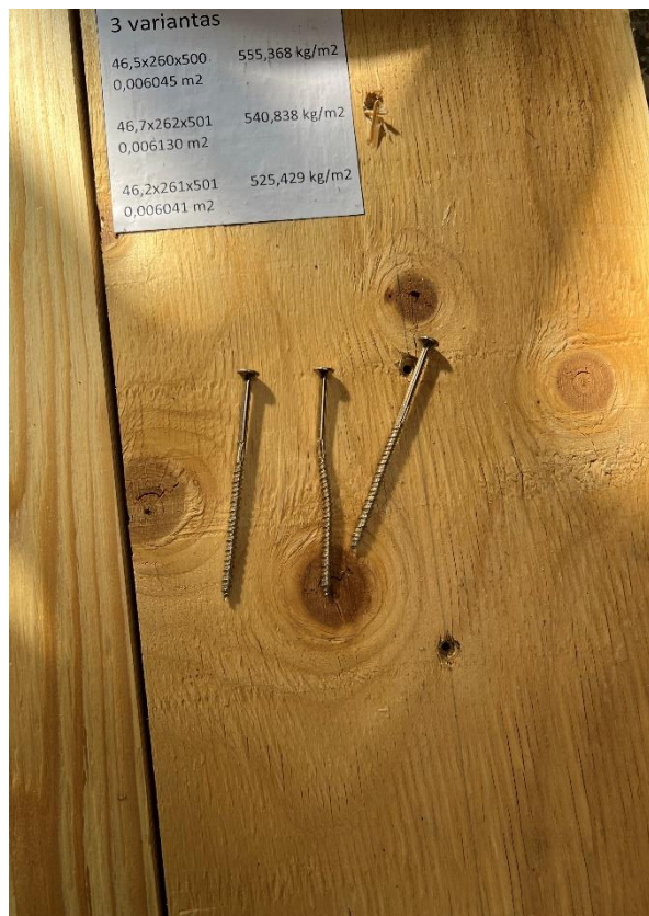
3.18 pav. Medienos jungties su medsraigčiais suirimo forma: lėtas medsraigčių tekėjimas, deformavosi medsraigčiai
