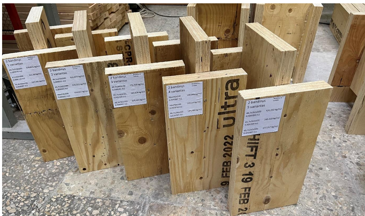
3.16 pav. Medinių jungčių su medsraigčiais eksperimentui paruošti bandiniai
