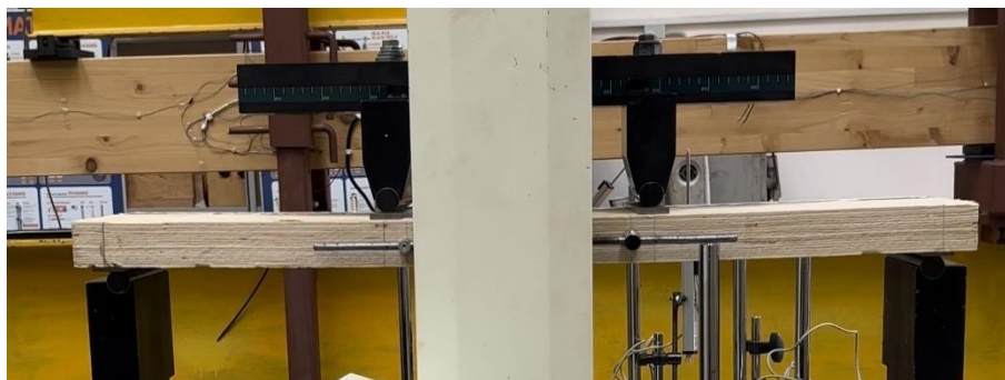
3.5 pav. Sluoksninės lukštų medienos plokštės lenkiamojo stiprio eksperimentas
