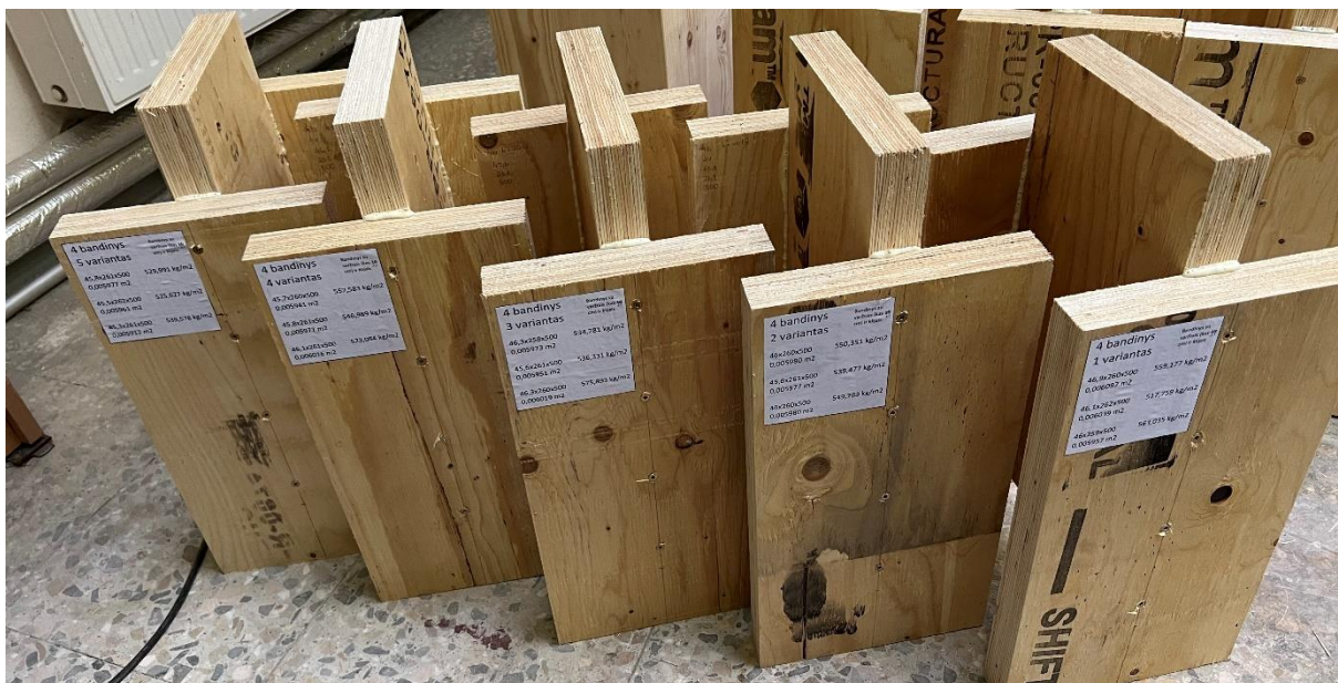
3.22 pav. Medinių jungčių su kljais ir suspaustų 6 medsraigčiais eksperimentui paruošti bandiniai
