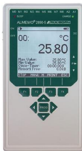
3.9 pav. Poslinkių ir apkrovos fiksavimo įrenginys ALMEMO 2890-9
