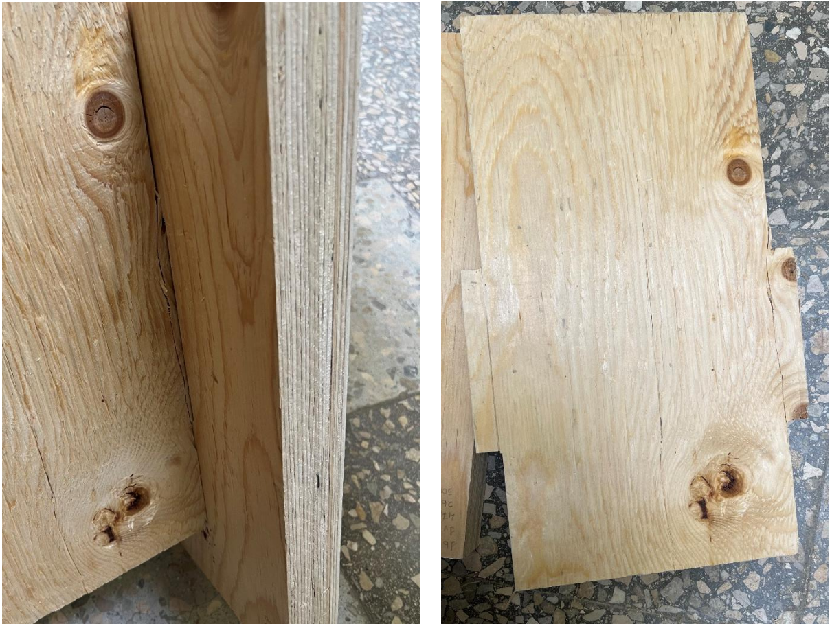
3.14 pav. Medienos jungties su išpjova suirimo forma: iškišos skilimas išilgai pluošto
