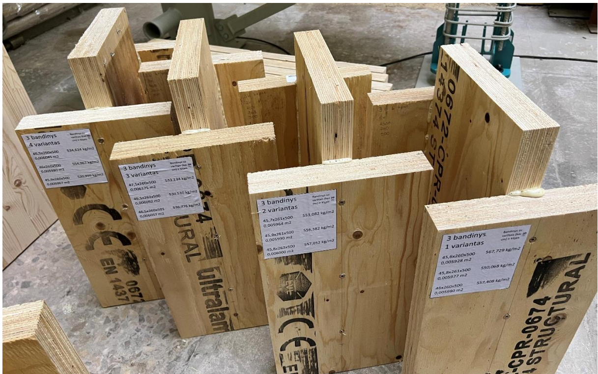
3.20 pav. Medinių jungčių su klijais ir suspaustų 6 medsraigčiais eksperimentui paruošti bandiniai
