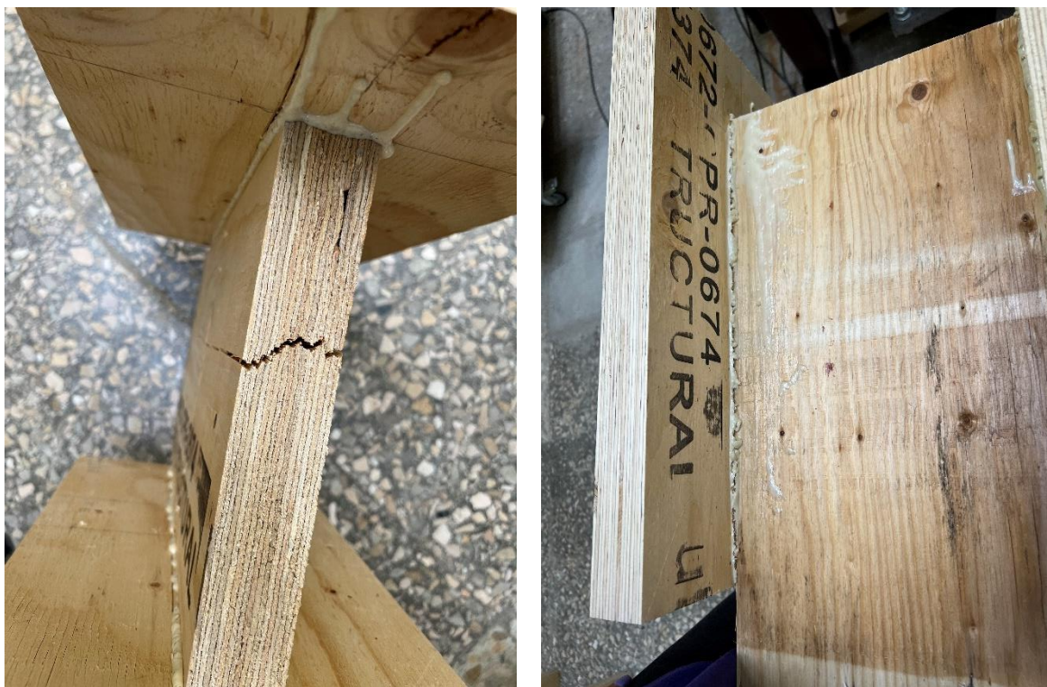
3.25 pav. Medienos jungties su klijais suirimo forma
