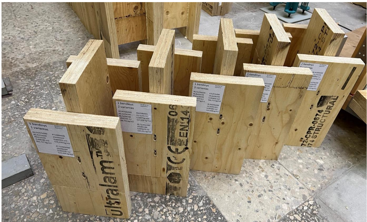
3.12 pav. Medinių jungčių su išpjovomis eksperimentui paruošti bandiniai
