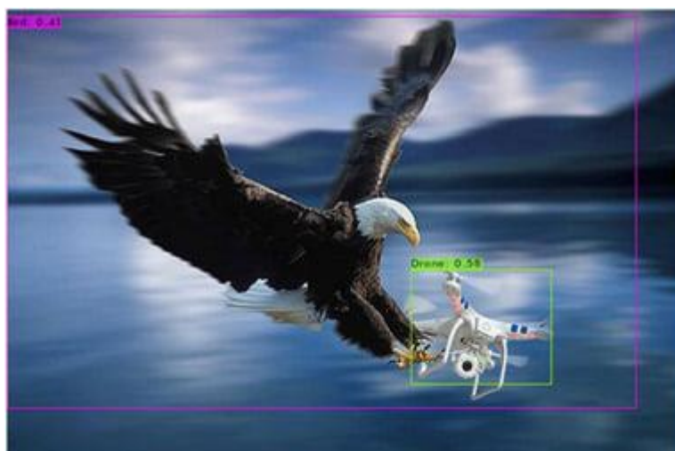
1.20 pav. Dronų ir paukščių aptikimo rezultatas su ribojančiais langais ir klasių tikimybėmis (Singha & Aydin, 2021)
