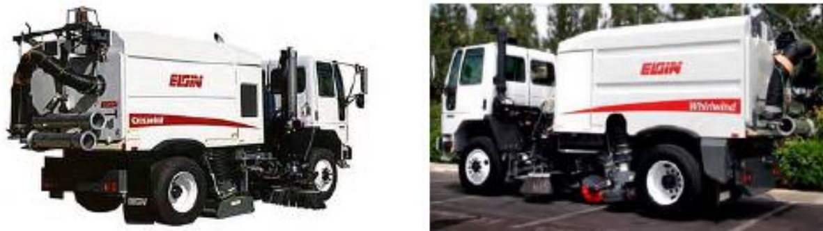
1.17 pav. Regeneracinė šlavimo mašina (kairėje), Vakuuminė šlavimo mašina (dešinėje) (TYMCO, n.d.)
