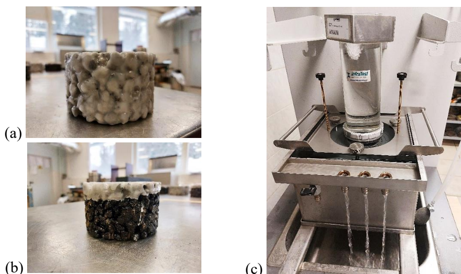
2.24 pav. Vertikalaus (a) ir horizontalaus (b) pralaidumo vandeniui nustatymas (c) pagal LST EN 12697-19:2020
