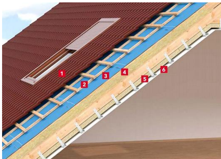
1.2 pav. Palėpės stogo izoliacija (Udiena, 2020)
