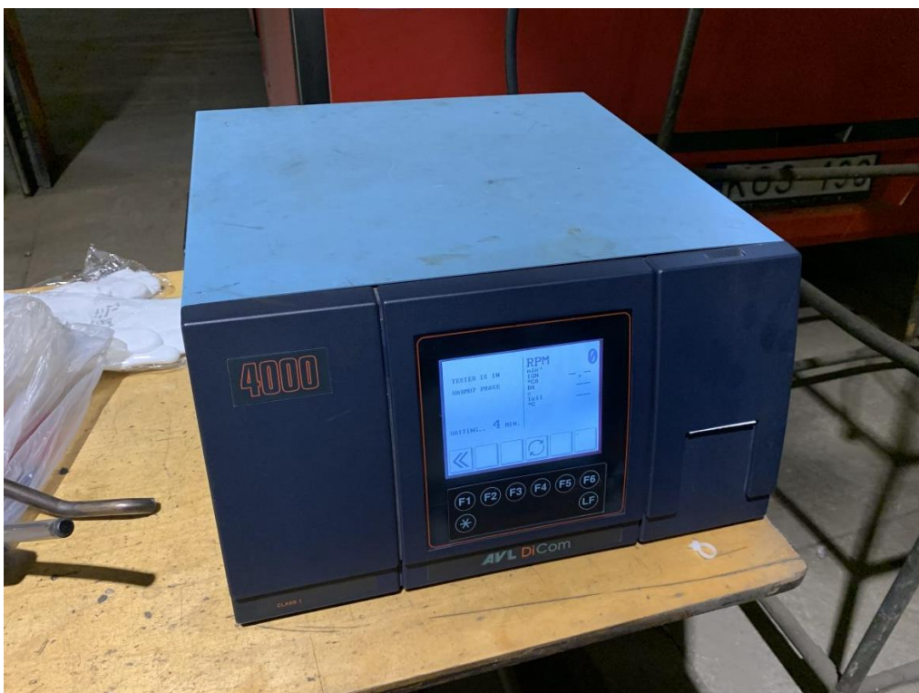
3.3 pav. „AVL DiCom 4000“ deginių analizatorius (sudaryta autoriaus)
