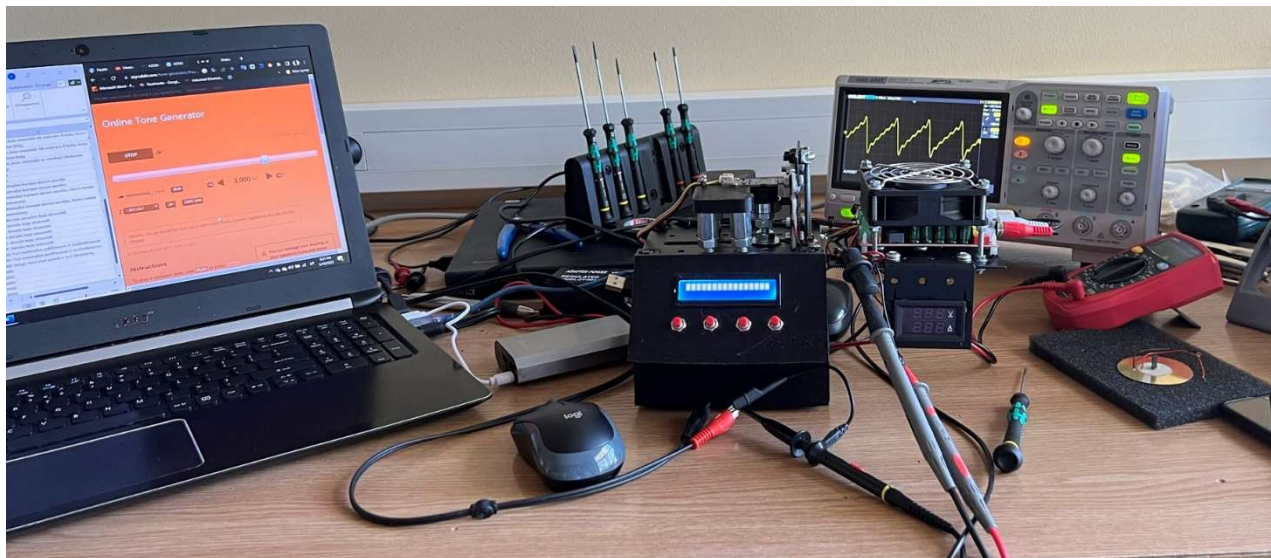
2.19 pav. Valdymo signalo bangos analizės aplinka, kai analizuojamas signalas, be garso stiprintuvo
