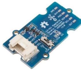
2.13 pav. 12 bitų padėties jutiklis AS5600 jutiklio bendras vaizdas
