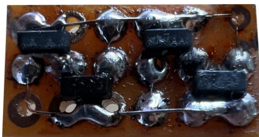
3.20 pav. MOSFET SI2302 ir SI2377 tranzistorių lygintuvas
