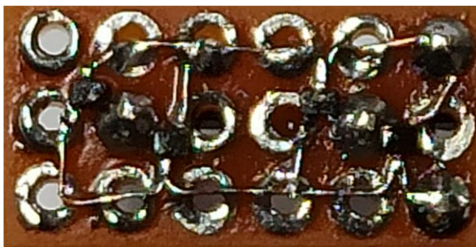
3.28 pav. RZM002P02T2L ir RUM002N05T2L tranzistorių lygintuvas
