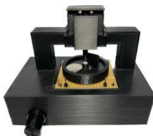
3.13 pav. Reguliuojamo fiksuoto ir stabilaus greičio magneto sukimo aparatas su keitiklio maketu
