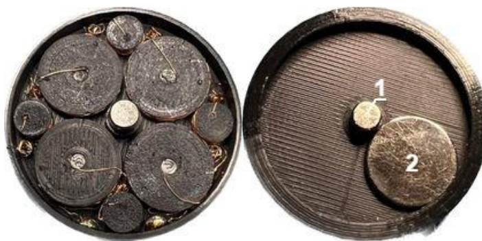
3.4 pav. Sukonstruotas keitiklio maketas: kairėje pusėje išdėstytos ritės, dešinėje pusėje uždengimas su besisukančiu magnetu
