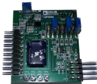
2.9 pav. ADP5090-2-EVALZ vertinimo plokštė
