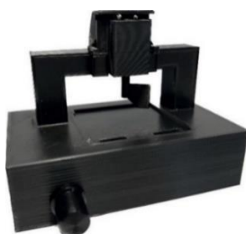
3.12 pav. Reguliuojamo fiksuoto ir stabilaus greičio magneto sukimo aparatas
