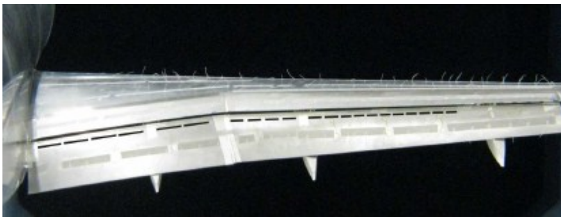
9 pav. Sparno ir užsparnio modelis su AFC sistema (Ciobaca et al. 2013)
