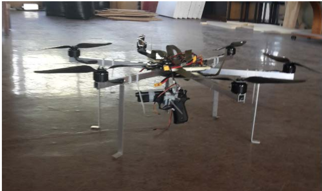
25 pav. Surinktas unikalus daugiasraigis sukasparnis „Meganeuropsis“ su prikabintu ginklu ir valdymo mechanizmu
