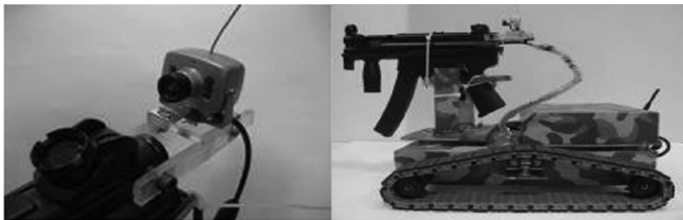
4 pav. Ginkluotas robotas su ties taikinosi linija pritaisyta kamera, sukalibruota su ginklo taikikliu (Wang et al. 2010)
