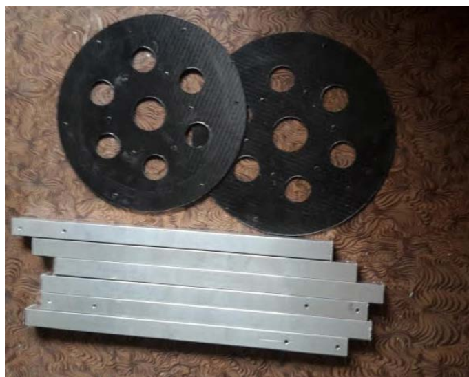
22 pav. Sukasparnio centrinės plokštės ir variklius laikančios kojelės
