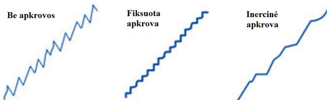
3.8 pav. Žingsninio variklio vibracijų kreivės, kai variklis be apkrovos, su fiksuota apkrova ir inercine apkrova [17]
