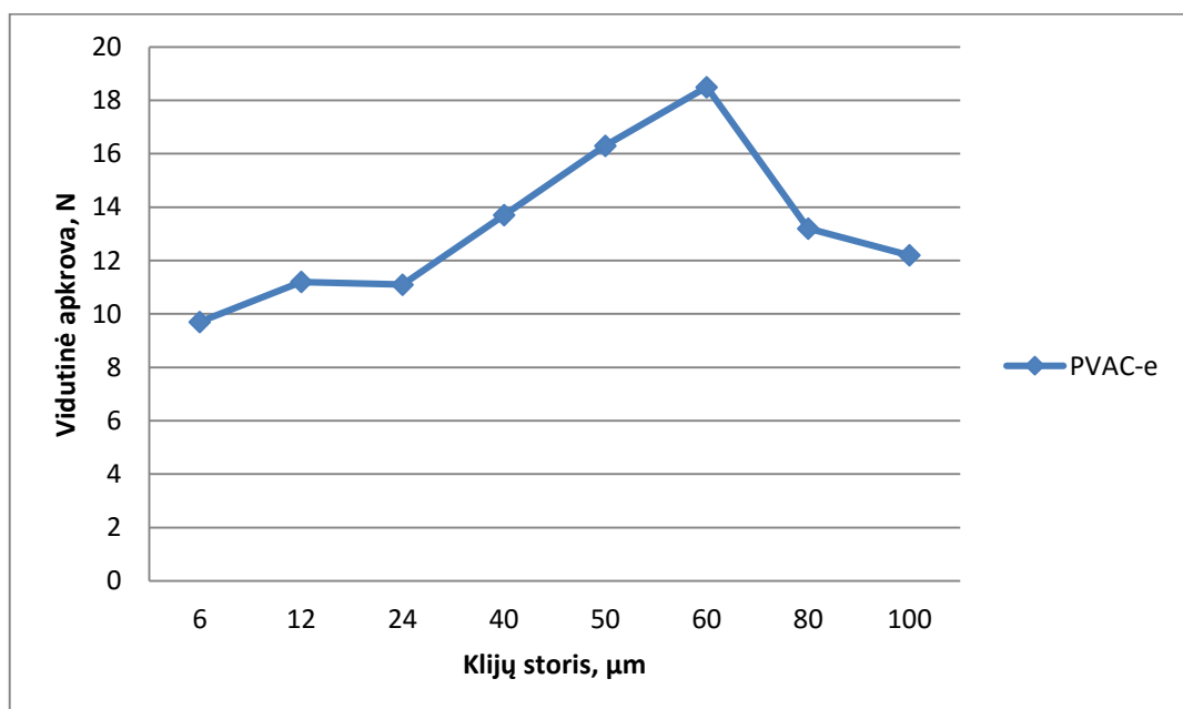
21 pav. Kartono GD1 Multiboard ir PVAC-e klijų bandymų maksimalios jėgos rezultatai
