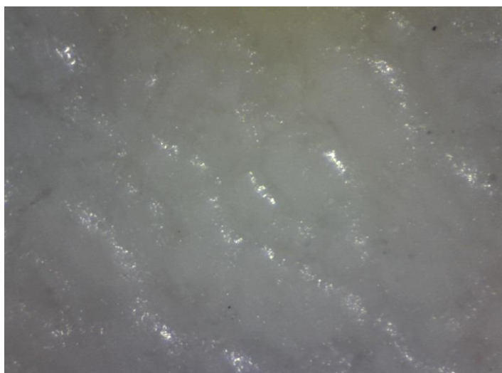
20 pav. Klijų sluoksnio vaizdas per mikroskopą, po plyšimo per klijų sluoksnį.
