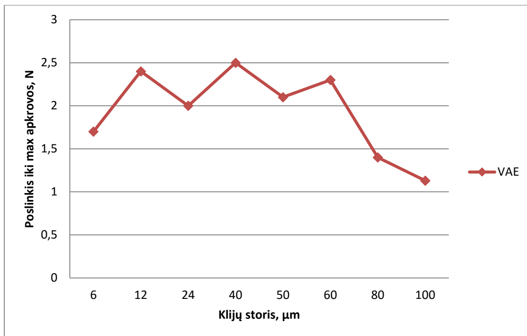
26 pav. Kartono GD1 Multiboard ir VAE klijų bandymų poslinkio iki maksimalios apkrovos rezultatai
