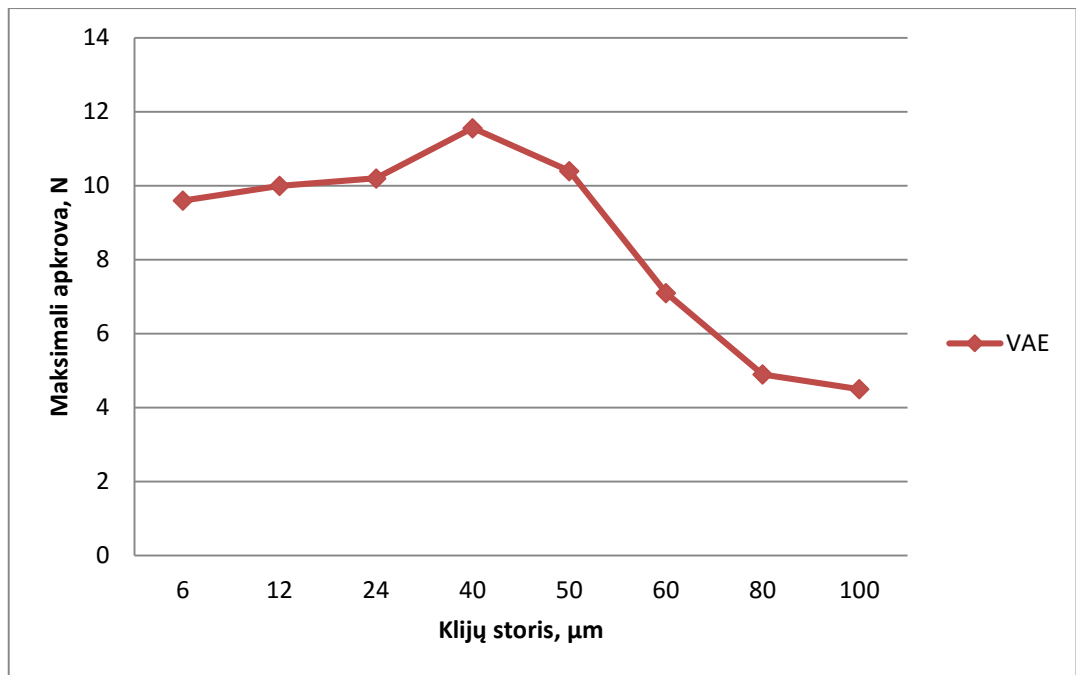
24 pav. Kartono GD1 Multiboard ir VAE klijų bandymų maksimalios jėgos rezultatai
