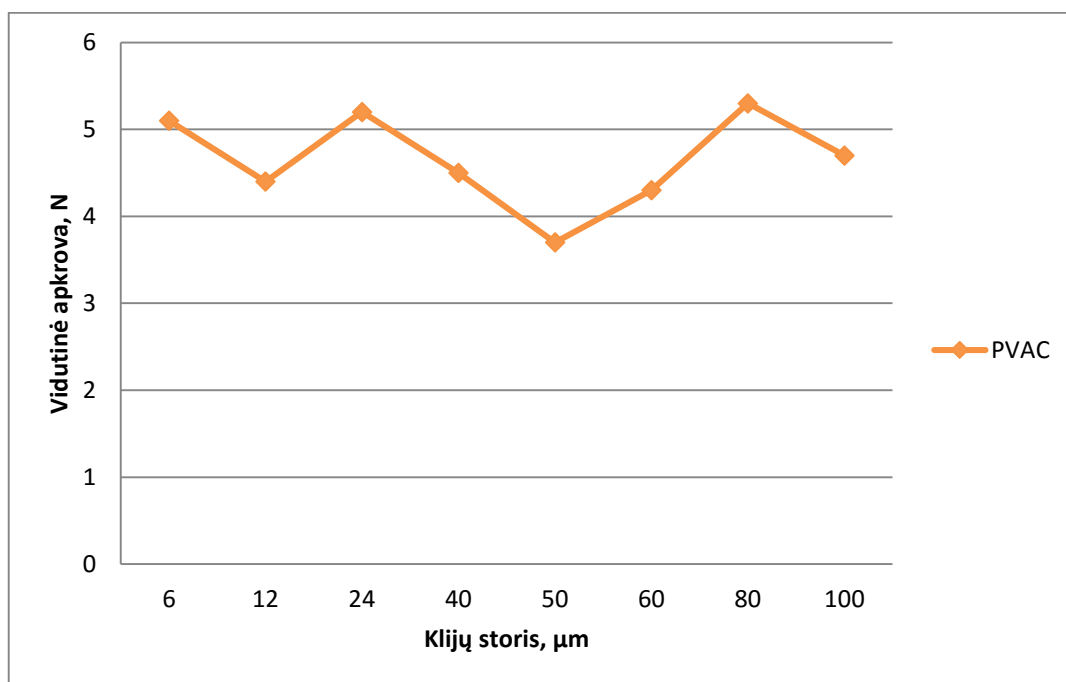
27 pav. Kartono GD1 Multiboard ir PVAC klijų bandymų maksimalios jėgos rezultatai
