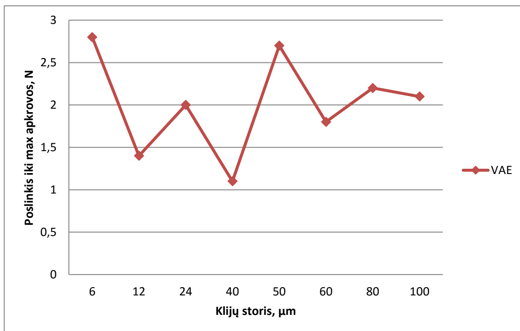
35 pav. Kartono GC1 Arktika ir VAE klijų bandymų vidutinės jėgos rezultatai
