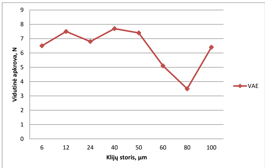
24 pav. Kartono GD1 Multiboard ir VAE klijų bandymų maksimalios jėgos rezultatai
