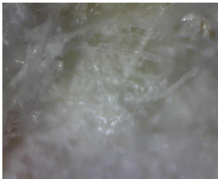
30 pav. Popieriaus vidinių sluoksnių atsiskyrimas
