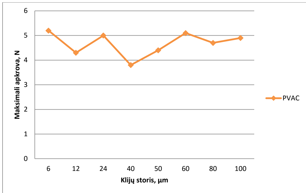
37 pav. Kartono GC1 Arktika ir PVAC klijų bandymų maksimalios jėgos rezultatai
