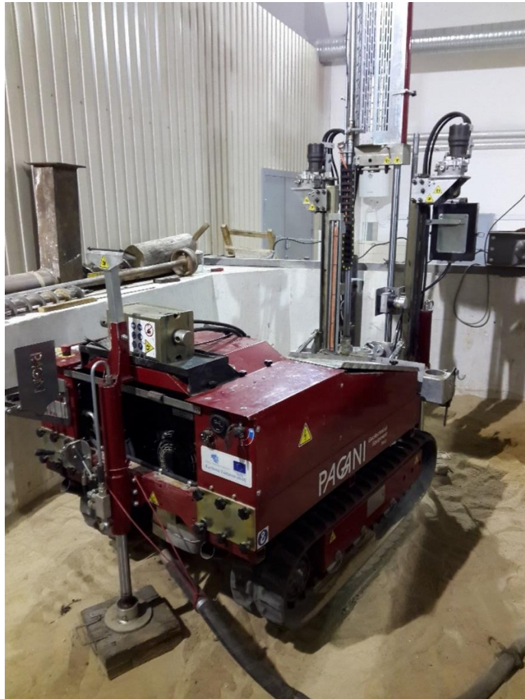
5 pav. Zondavimo įranga paruošta bandymui, pamatų bandymo stende
