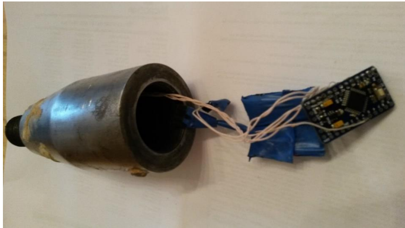
3 pav. Modifikuotas zondavimo kūgis
