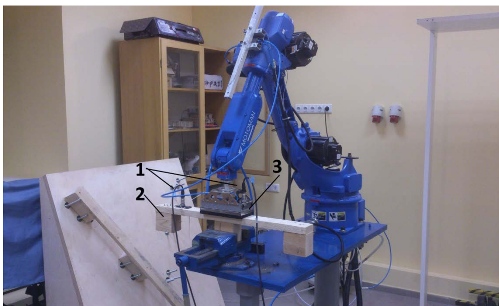
4.2 pav. Pramoninis robotas „MOTOMAN SSF2000“ su vakuuminiu griebtuvu „UNIGRIPPER“ ir paletės ruošiniu.
