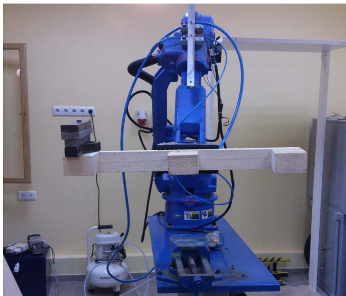
4.3 pav. Robotas „MOTOMAN SSF-2000“ su vakuuminiu griebtuvu „UNIGRIPPER“ jėgos reikalingos trinčiai tarp ruošinio ir griebtuvo nugalėti nustatymas.
