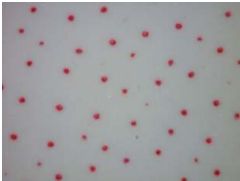
25 pav. Magenta spalvos bandomoji spauda (1 %) ant popieriaus naudojant XSOFTE 52018 montavimo juostą (padidinta 200 kartų)
