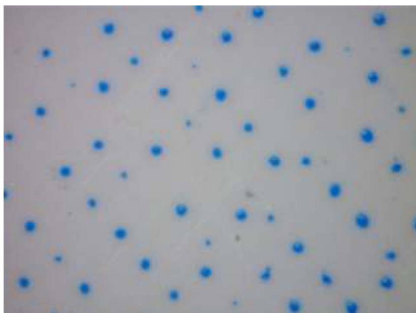
26 pav. Cyan spalvos bandomoji spauda (1 %) ant popieriaus naudojant XSOFTE 52018 montavimo juostą (padidinta 200 kartų)
