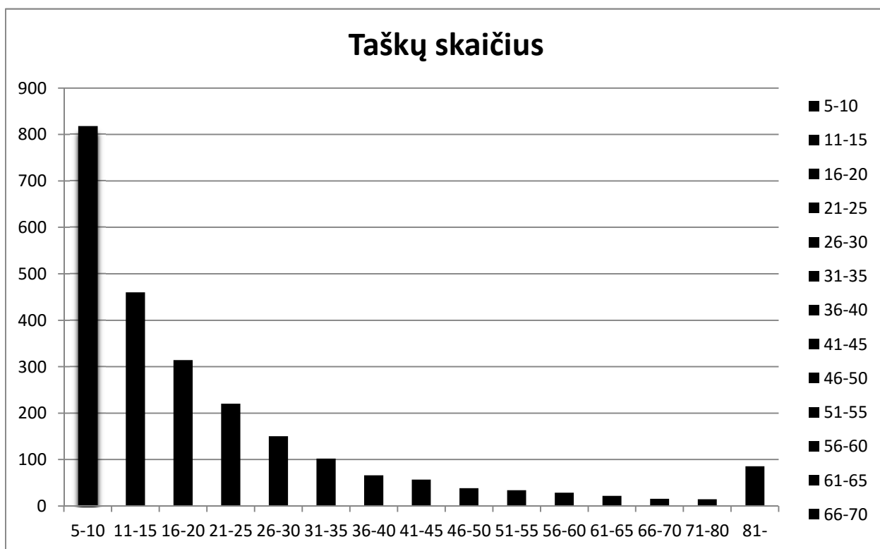
16 pav. Ištisinių juodos spalvos laukelių baltų taškų skaičiaus pasiskirstymas pagal dydžius. Montavimo juosta TESA Steel master SOFT 52017
