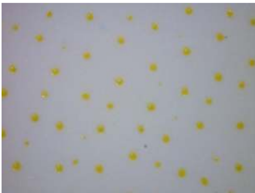
24 pav. Geltonos spalvos bandomoji spauda (1 %) ant popieriaus naudojant XSOF 52018 montavimo juostą (padidinta 200 kartų)
