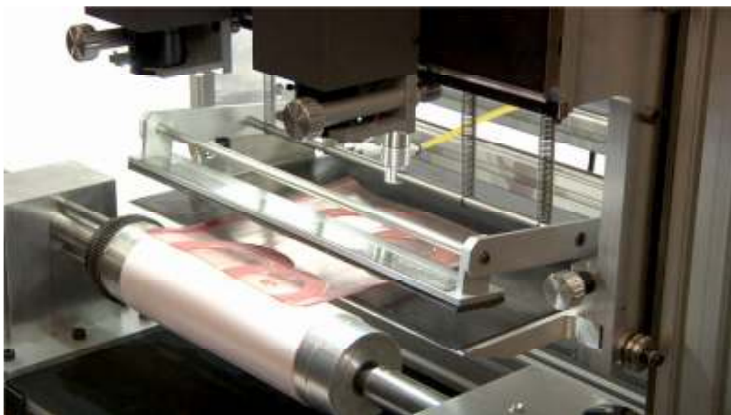
3 pav. Spausdinimo formos montavimas ant formų cilindro
