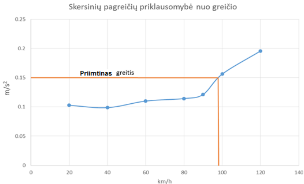
56 pav. Keleivinio vagono kėbulo skersinių pagreičių priklausomybės nuo vagono judėjimo greičio grafikas ( v = 120 \text{ km/h} )
