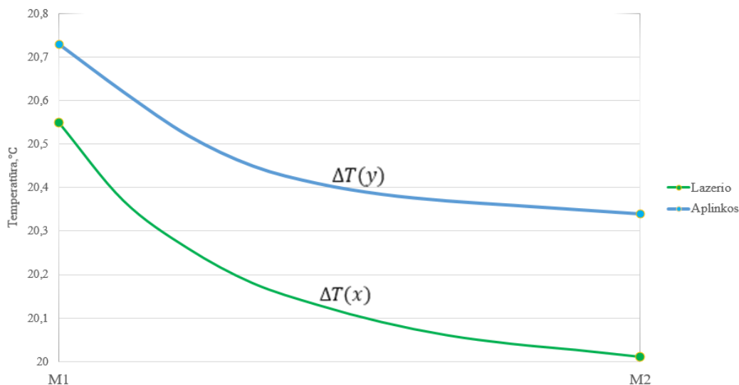
9 pav. Juostos skerspjūvio vidutinio temperatūrinio gradiento pasiskirstymas tarp M1 ir M2 esant lazerio ir aplinkos įtakai
