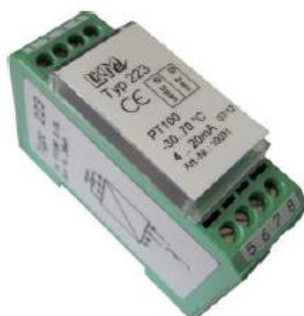
3.8 pav. Temperatūrinis imtuvas LKM 223 (PT100 temperature transmitter)
