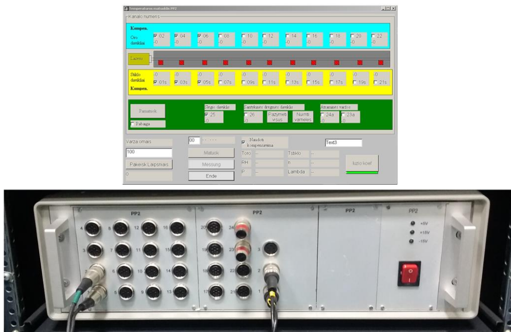
3.30 pav. Temperatūros matuoklis PP2 (eksperimento metu užpildomos visos 22 jungtys) bei programos langas – viršuje
