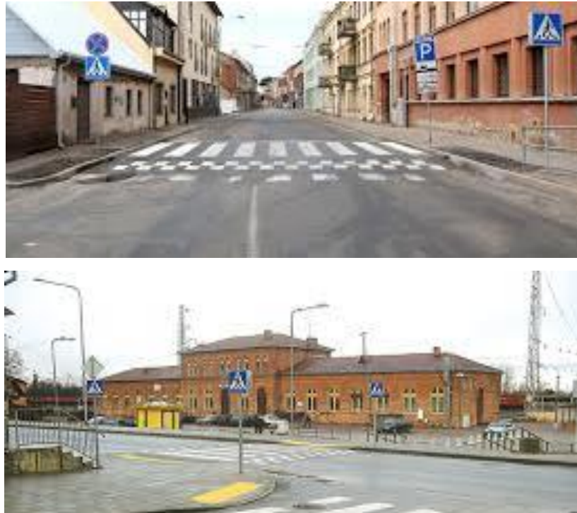
19 pav. Iškilųjų pėsčiųjų perėjų pritaikymo pavyzdžiai (Šaltinis Google Street View)
