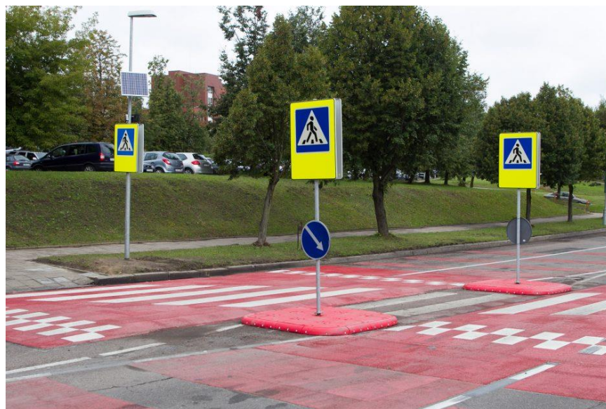
17 pav. Iškilioji pėsčiųjų perėja su iškiliosiomis salelėmis
