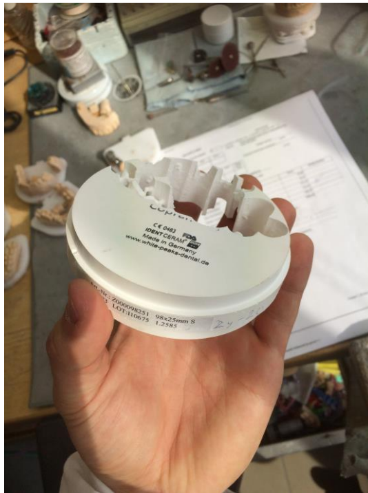
14 pav. „Išfrezuoti cirkonio oksido karkasai“
