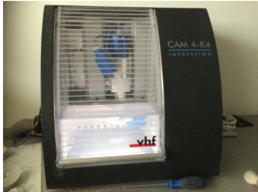
13 pav. „Cirkonio oksido frezavimas su CAM 4-K4“
