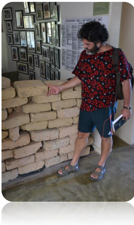
2.10.1 pav. prof. Mark Swilling demonstruoja iš kanapių spalių ir molio pagamintas plytas
