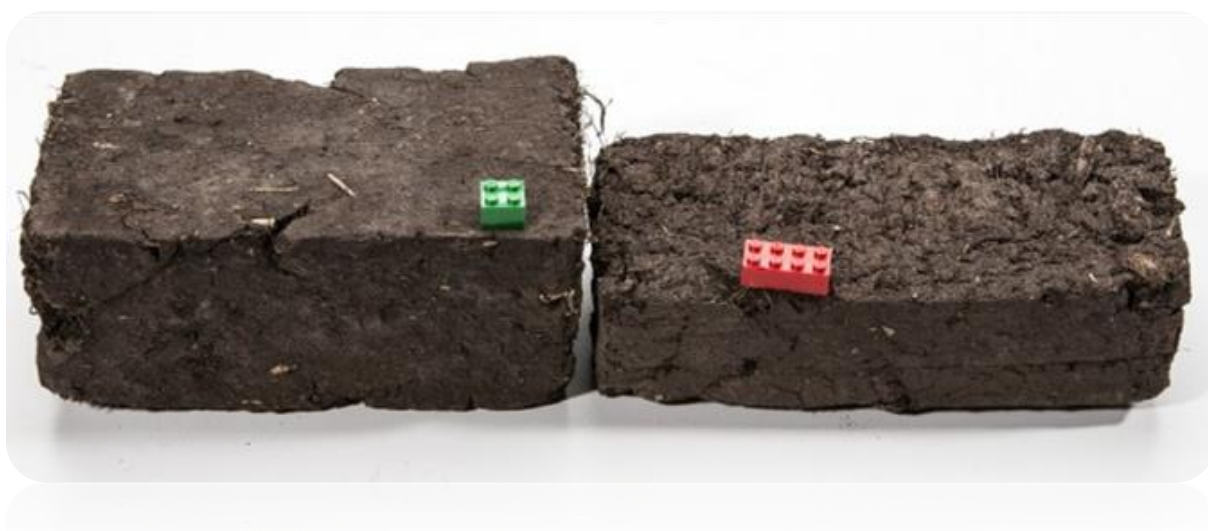
2.10.6 pav. Nyderlanduose gaminamų statybinių bioblokelių iš durpių pavyzdžiai
