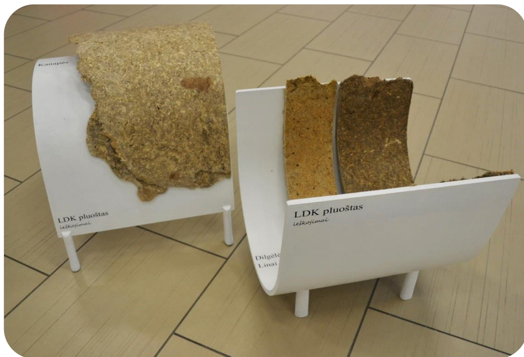
2.7.3.1 pav. Vakuuminiu presu suformuotų lenktų eksperimentinių biomedžiagų fragmentai. Doktorantų darbų paroda „Išsklotinė“, 2014.04.20.-05.21.
