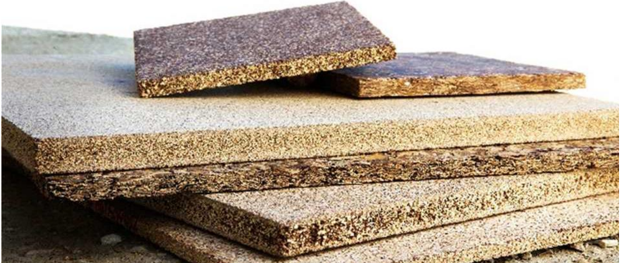
3.11.4 pav. Konstrukcinės medžiagos iš ryžių, kukurūzų ir maniokų pluoštų, 2011. Nigerija
