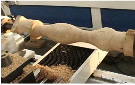
4.2.1.2 pav. Wolffurniture, 2012. Elemento pavyzdys tekinimo procese bei baldų konstrukcijoje
