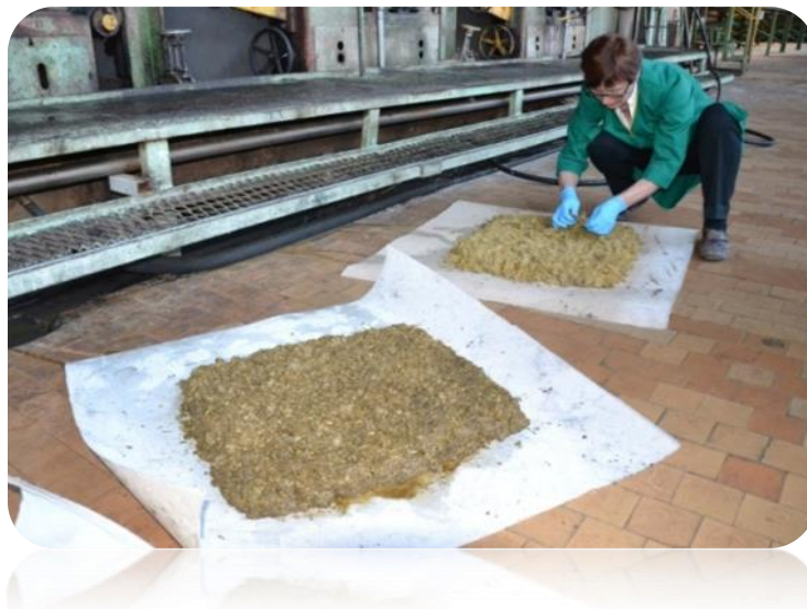
2.6.2.2 pav. Linų, dilgėlių ir kanapių plaušų paskirstymas formuojant „kilimus“
