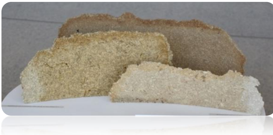
2.7.2.2 pav. Lenktų formų bandiniai iš linų, dilgėlių ir kanapių biomasės, gauti formuojant karštu presu
