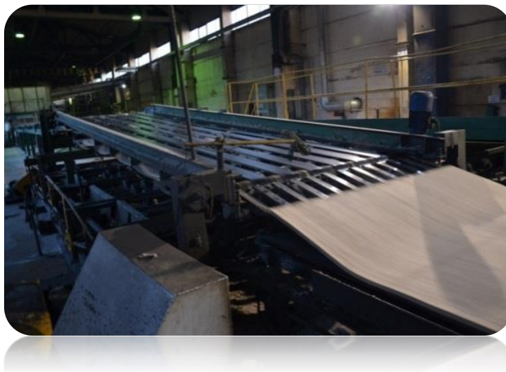
2.6.2.1 pav. Medienos plaušų plokštės gamybos linijos fragmentas
