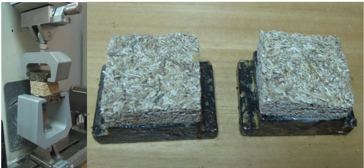
2.3.2.1 pav. Plokštės vidinės sankibos bandinys
