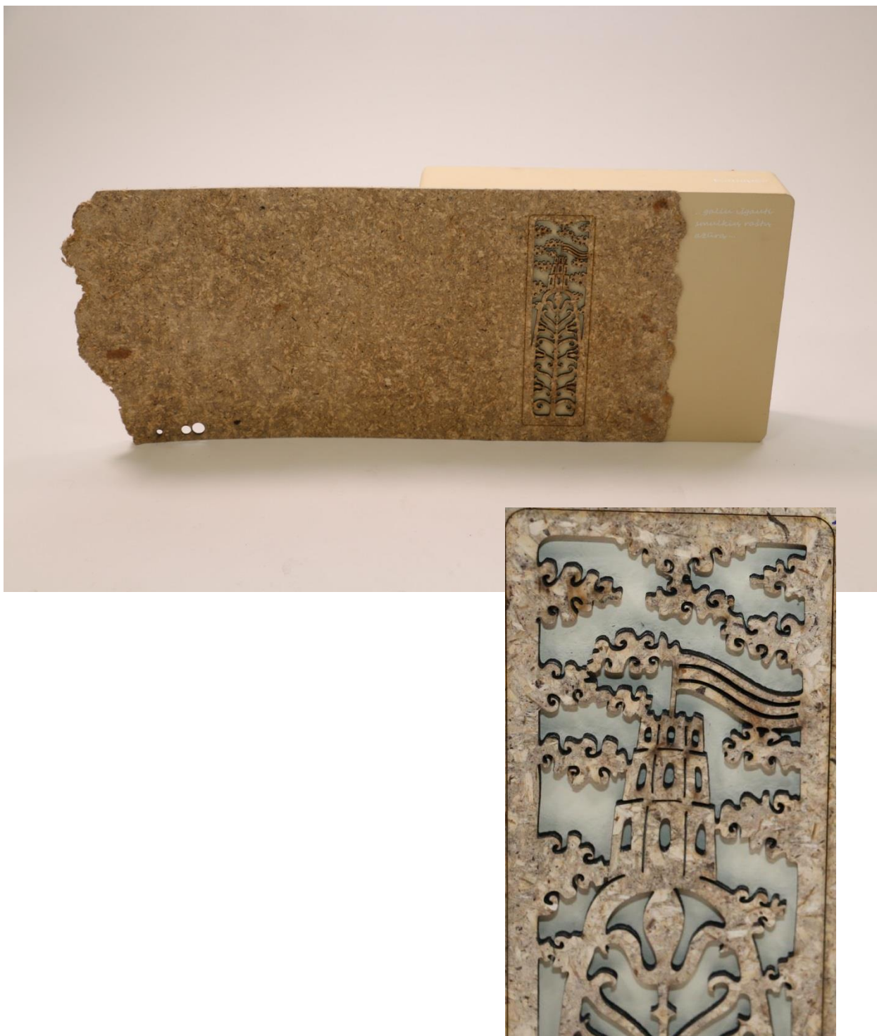
Konstruktinė medžiaga iš LDK pluošto. Inga Valentinienė, 2014 kovas, Kaunas. Kanapių plaušų plokštė. Pjaustymas lazeriu. Medžiagos tinkamumo smulkaus rašto išpjaustymui eksperimentas. Asmeninis I. Valentinienės archyvas
