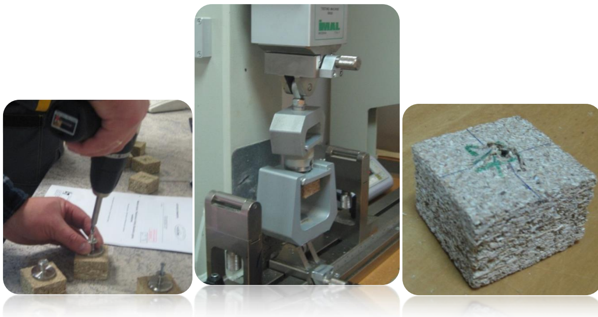
2.3.4.1 pav. Furnitūros ištraukimo iš plokštės bandymas
