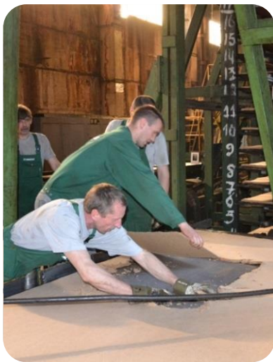
2.6.2.5 pav. Į medienos plaušų plokštės „kilimą“ talpinami linų, dilgėlių ir kanapių plaušų masės „kilimai“
