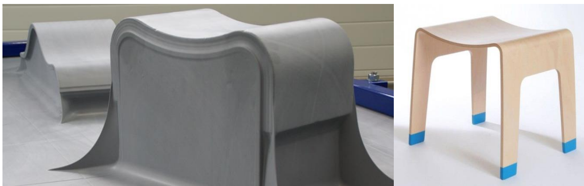
4.1.3.1 pav. Elementų formavimas veikiant vakuumu po preso membrana
