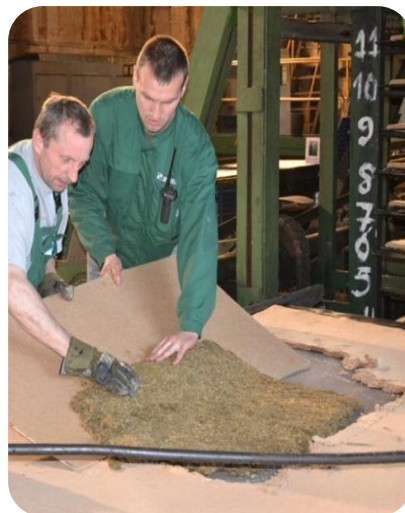
2.6.2.5 pav. Į medienos plaušų plokštės „kilimą“ talpinami linų, dilgėlių ir kanapių plaušų masės „kilimai“
