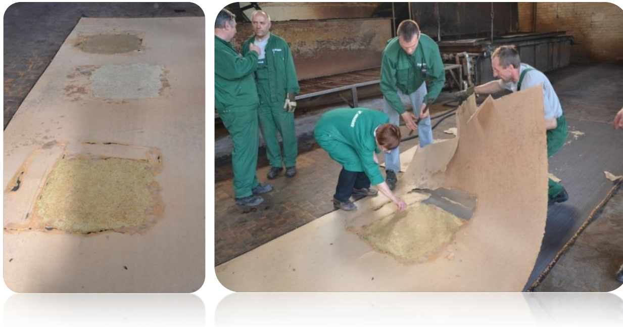
2.6.2.7 pav. Daugiatarpiniame prese suformuotas eksperimentinis plaušų plokštės lakštas
