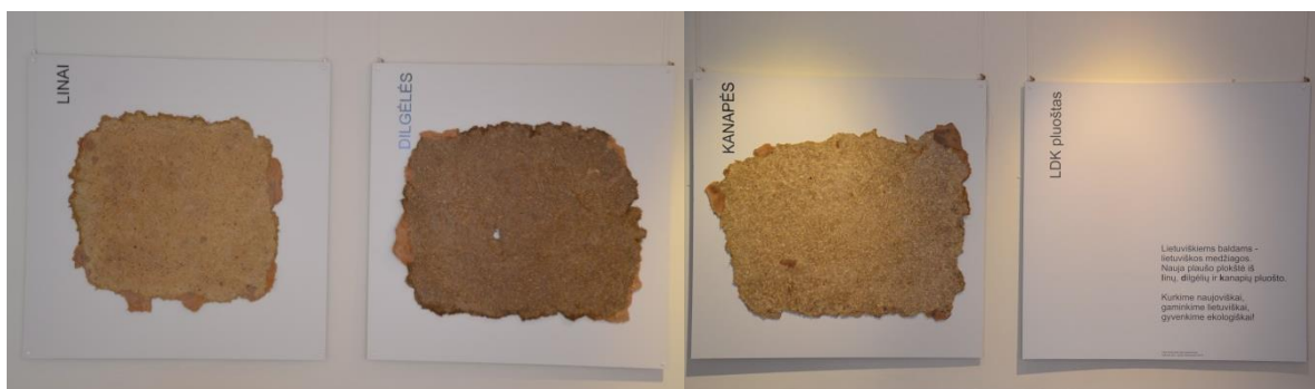
2.6.2.8 pav. Pramoniniu būdu suformuotų eksperimentinių plaušų plokščių lakštų fragmentai doktorantų darbų parodos „Akademija“ metu, 2013 m. gegužės mėn.
