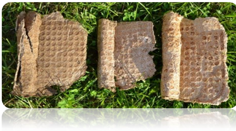
2.7.1.2 pav. Pirmas iš kairės – bandinys iš pluoštų ir šiaudų mišinio, vidurinis – iš dilgėlių pluošto, iš dešinės – iš linų pluošto
