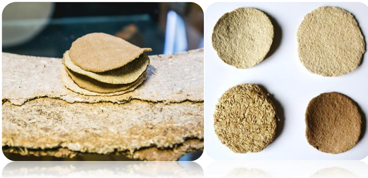
2.6.1.1 pav. Linų, dilgėlių ir kanapių pluoštų bandiniai, gauti nuvandeninus ir išdžiovinus plaušų masę. A- bandinių vaizdas iš šono, B – vaizdas iš viršaus
