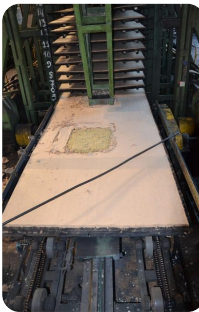
2.6.2.5 pav. Į medienos plaušų plokštės „kilimą“ talpinami linų, dilgėlių ir kanapių plaušų masės „kilimai“
