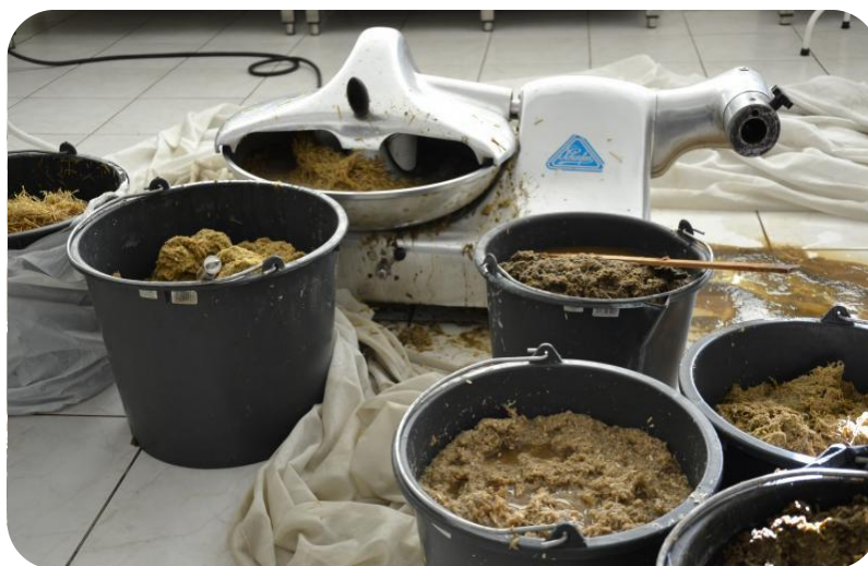
2.5.2 pav. Pluoštų smulkinimas mėsos kapokle
