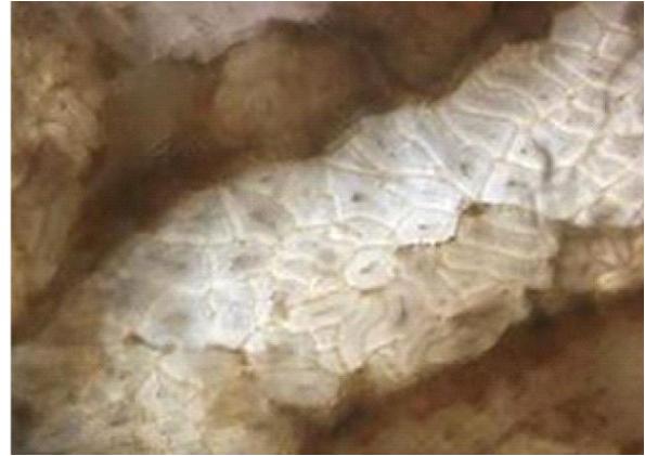
b) plaušelių vaizdas pluošto skerspjūvyje, išdidintas 200 kartų
