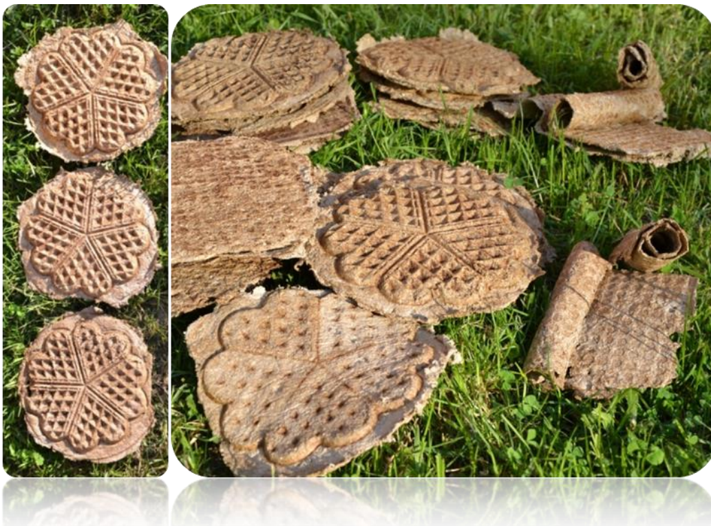
2.7.1.1 pav. Linų, dilgėlių ir kanapių pluoštų bandiniai, bandant jų konfigūravimo galimybes, formos išlaikymo bei relaksacines savybes
