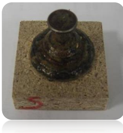
2.3.3.1 pav. Plokštės paviršiaus stiprio bandinys
