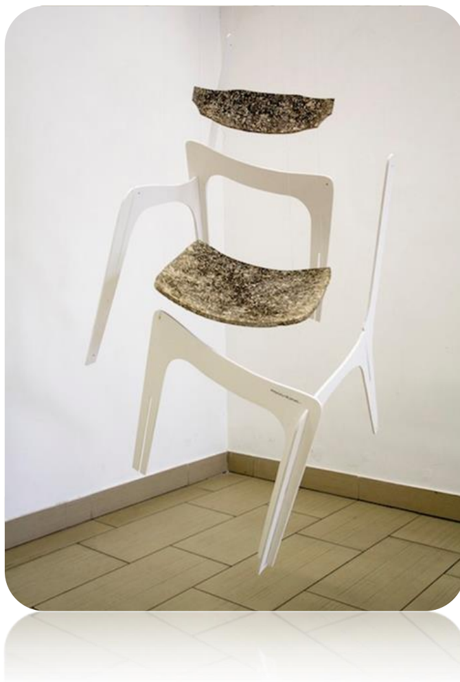
2.7.2.3 pav. Pramoniniu būdu suformuotų eksperimentinių kanapių biomasės baldinių lenktų elementų fragmentai. Doktorantų darbų paroda „Mnemosinės ledkalnis“. 2015.04.23.-05.09.
