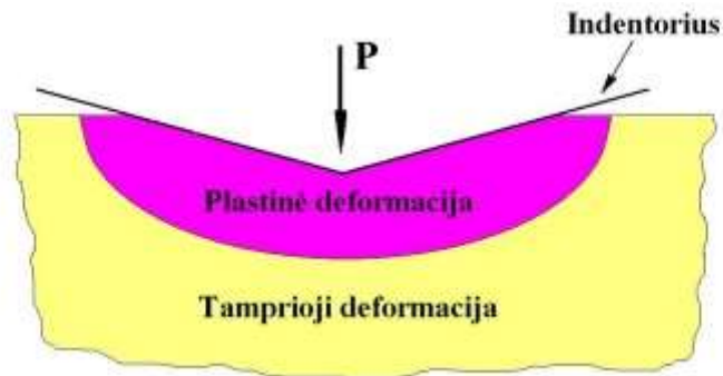
2.22 pav. Tamprioji ir plastinė deformacija matuojant kietumą Knopo metodu
