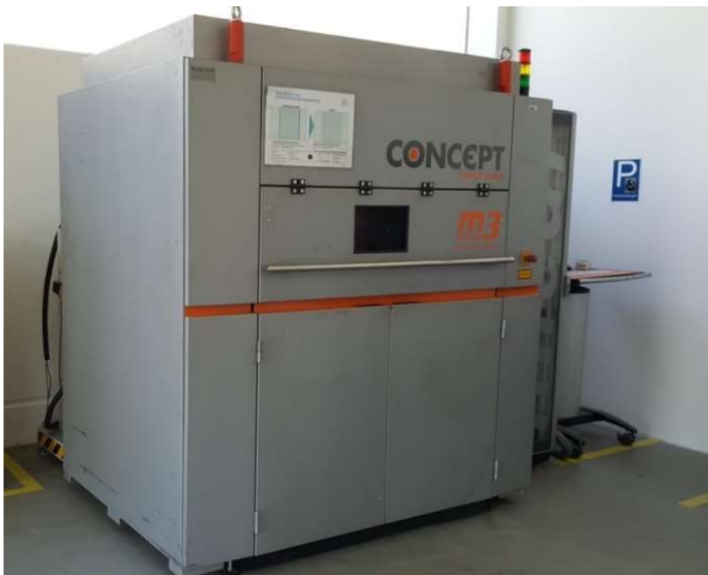
2.1 pav. Concept Laser M3 selektyviojo lazerinio sulydymo įrenginys
