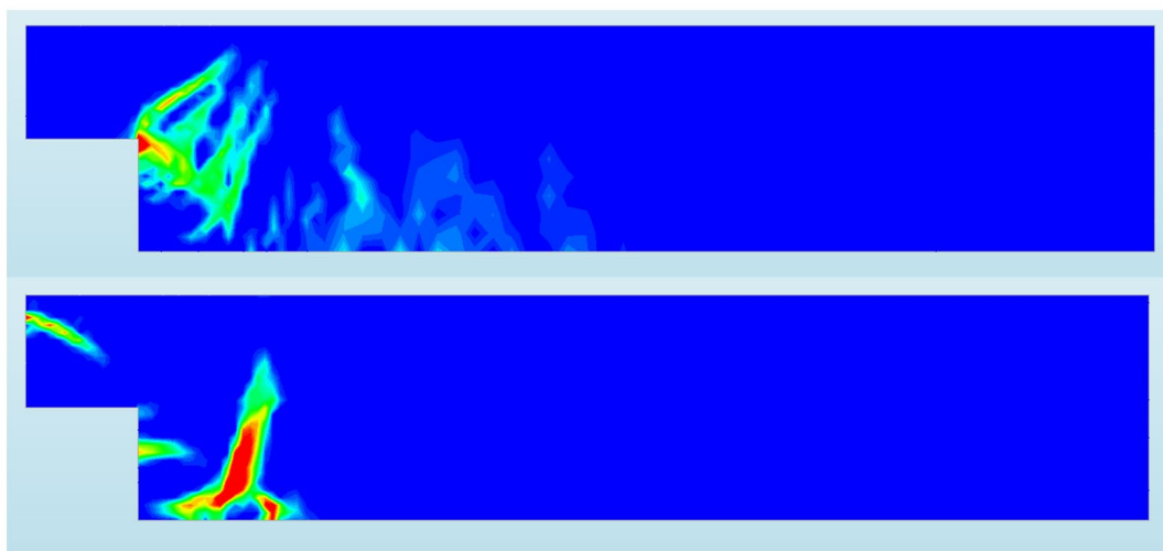
3.37 pav. Suirimas neįtempus armatūros (viršuje) ir įtempus (apačioje)
