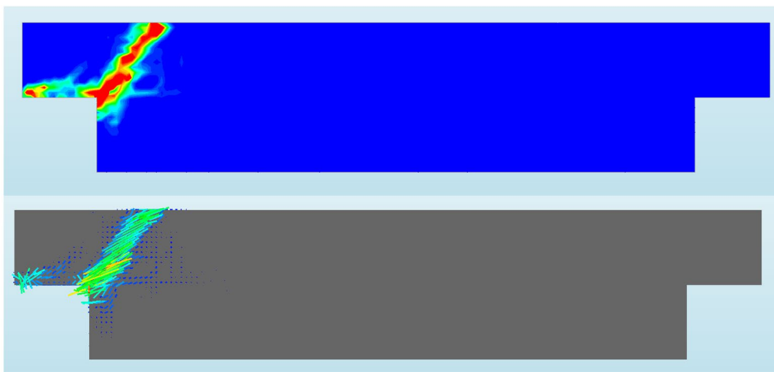
3.30 pav. Modifikuoto modelio deformacijos ir pleišėjimas
