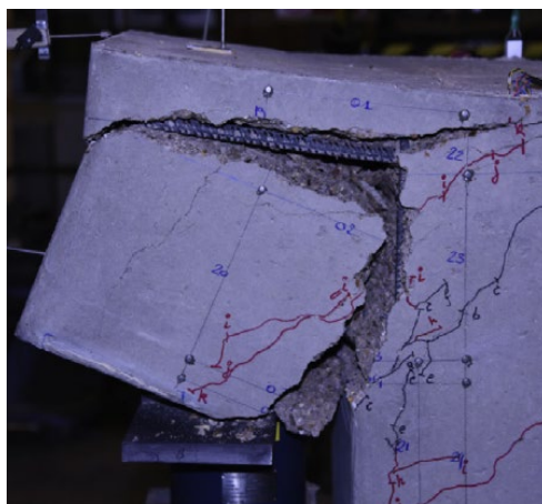
1.23 pav. 2 pobūdžio suirimas (Desnerck et al., 2016)
