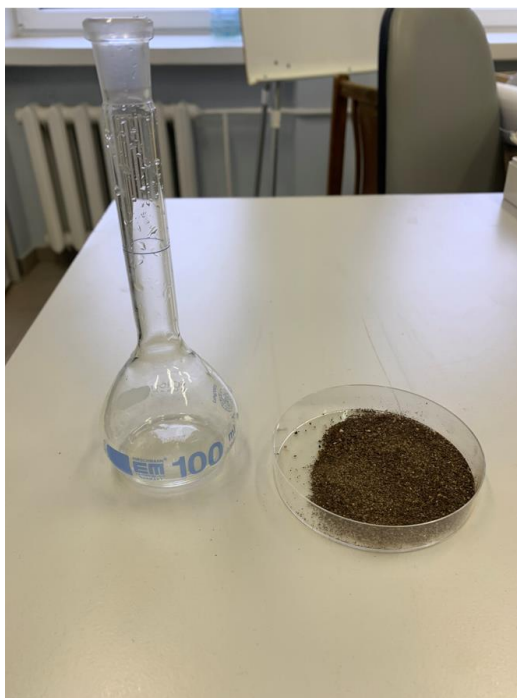
2.6 pav. Piknometrinis tankio nustatymas
